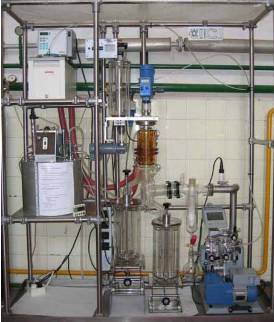
Figura 1.12. Destil·lador molecular on es va realitzar l'eliminació de l'anilina en models d'oli de colza.
