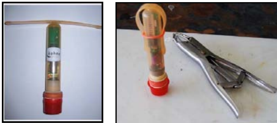
Figure 5.2 Bolo ruminal Kahne KB1001 para la medida del pH y temperatura.
