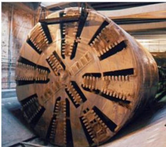
Figura 2.13. Tuneladora de La Almudena. Madrid. (Barqueros, 2009).
