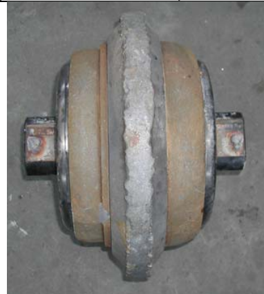
Figura 4.6: Aro desgastado en todo su recorrido
