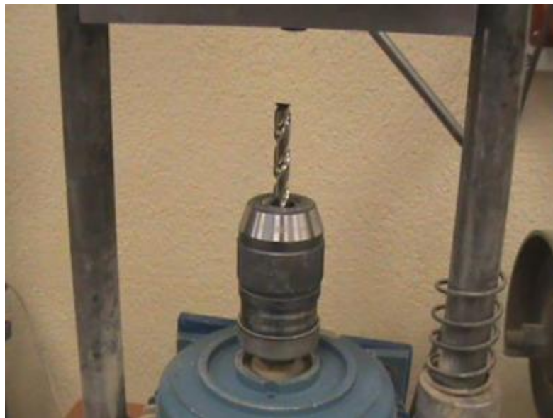
Foto 18: vista inferior del marco de ensayo, con la broca en su posición para perforar.
