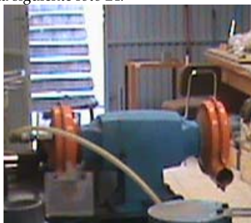
Foto 24: Aparato para pulir la muestra metálica que se emplea en ensayo AVS.
