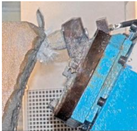
Figura 5.34: Ensayo de corte usando una pica de ataque puntual original. (Mineral Ground Tools Tunnelling, 2008)
