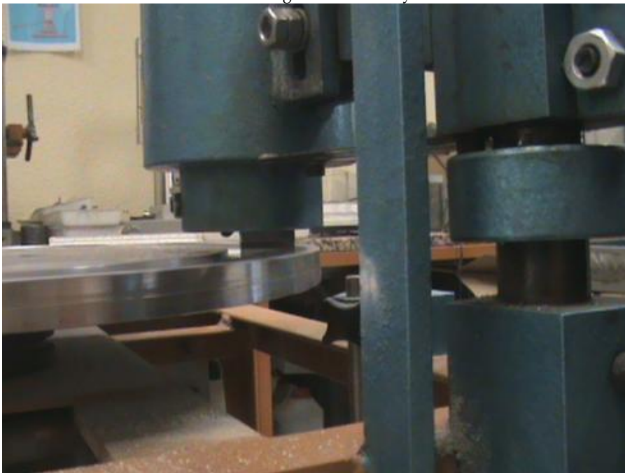
Foto 31: Detalle del roce de la pieza metálica con el material de roca triturado.
