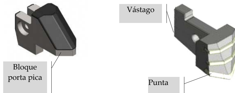
Figura 2.27 Partes de una pica adaptado de (Bartz, 2009)
