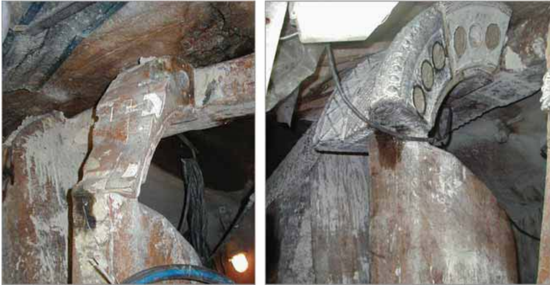
Figura 4.5: Rastrel: Herramienta de corte antes de ser reparada (a la izquierda) y luego de ser reparada (a la derecha). Túnel del Metro de Porto. (Nielsen B., 2006)
