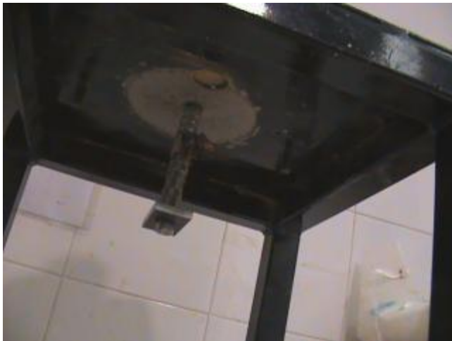
Foto 8: Vástago de rotación y paleta metálica, a la derecha orificio para introducir la muestra.
