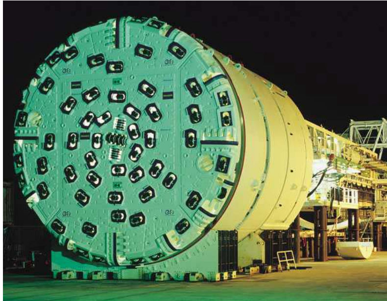
Figura 2.22: Ejemplo de diseño en espiral de una rueda de corte. Doble escudo de Perthus (Mendaña, 2008)
