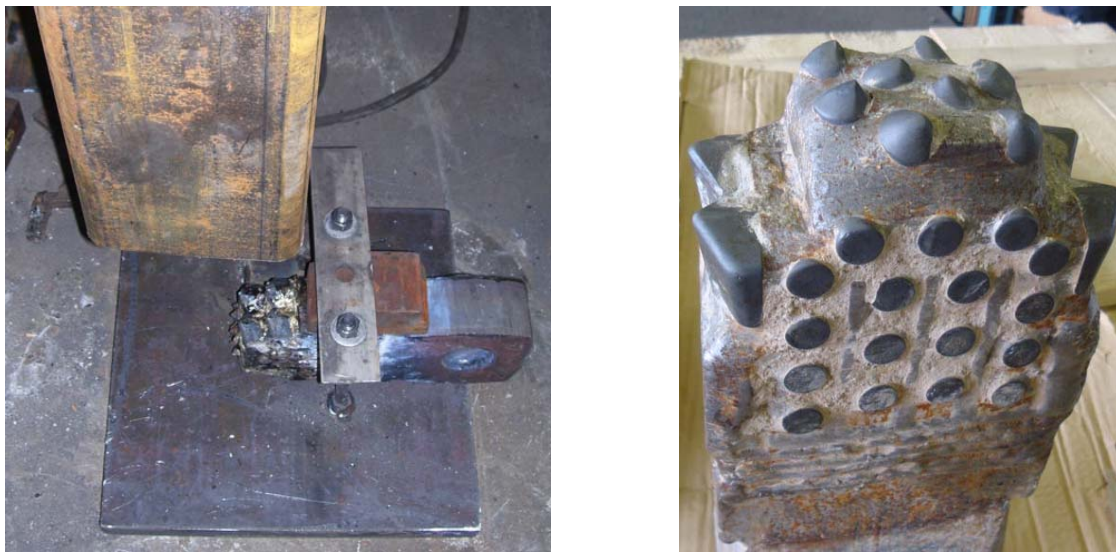
Figura 5.35: Ensayo Drop test. Muestra de herramientas reales, para ensayos. (Lovat, Inc., 2009)
