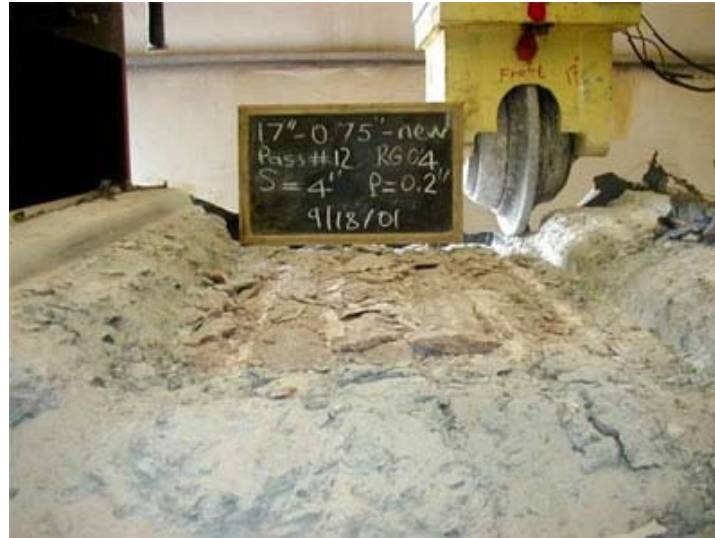
Figura 5.33: Ejemplo de ensayos con herramientas reales. (CSM, 2012)
