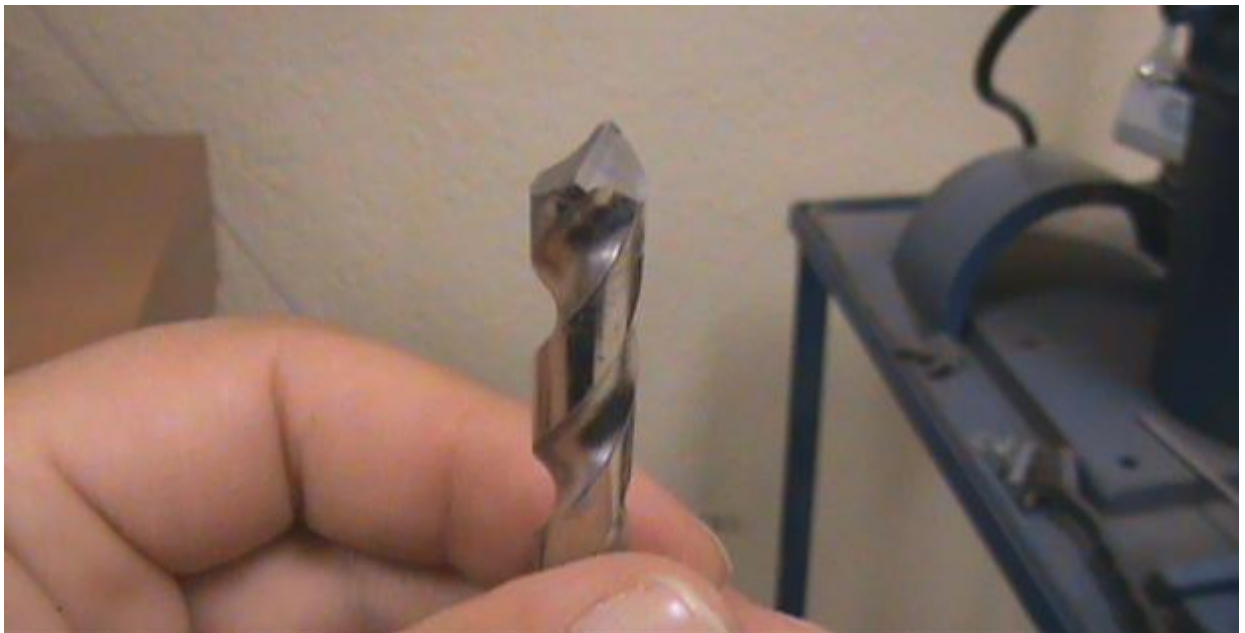
Foto 20: Detalle del extremo con inserto afilado de una barra o broca de perforación para el ensayo SJ.
