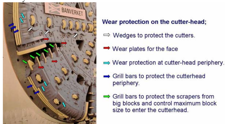
Figura 4.26: protecciones de desgaste en una cabeza de corte. (Burger, 2006)
