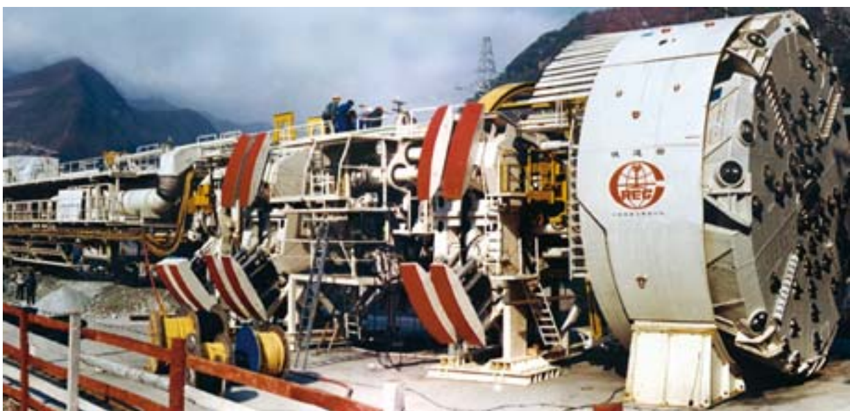
Figura 2.3. Cabeza de corte, y carro estructural de una tuneladora Topo. (Wirth-erkelenz,2009).
