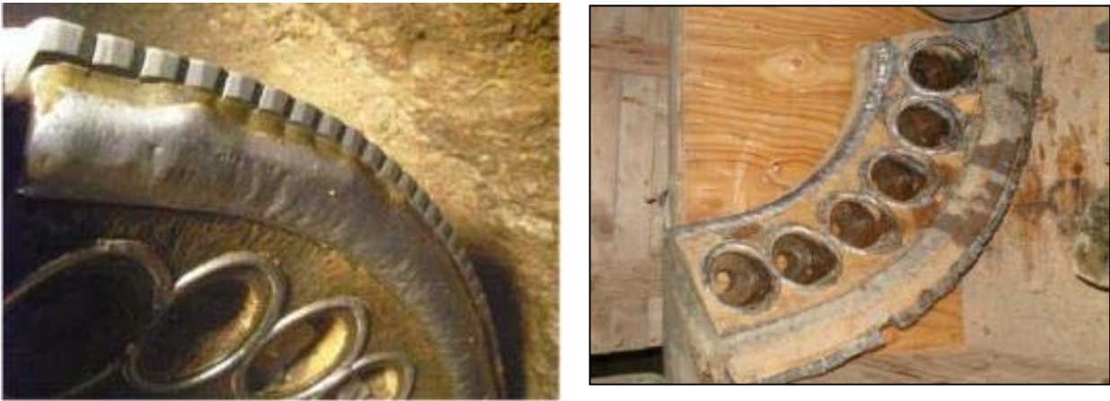
Figura 4.28: Rastreles.: (GORG, Revisión Rueda de Corte (S-442). 29/01/2010. P.K. 9+067'09, 2010)
