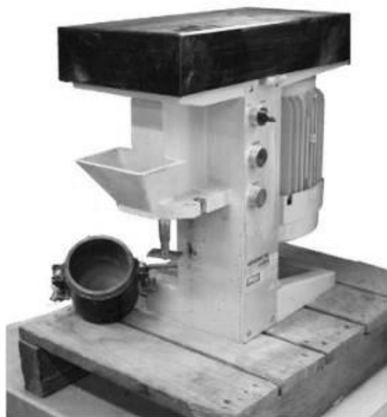
Figura 5.27: Aparato de ensayo LCPC (Mathier, 2002)
