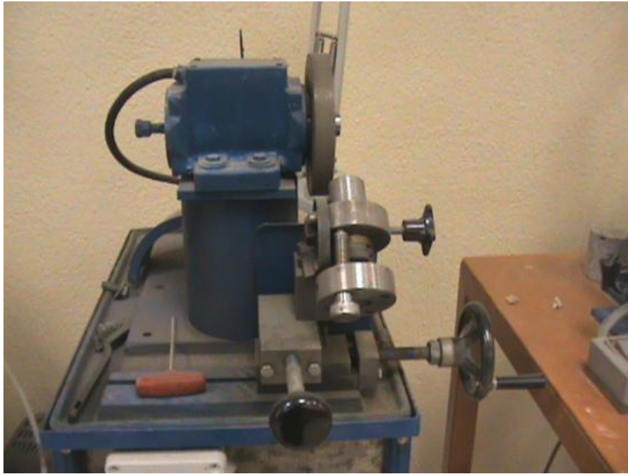
Foto 21: Dispositivo para pulido de las brocas metálicas para perforación en el ensayo de perforabilidad.
