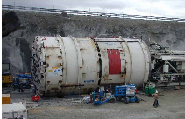
Figura 2.8: Doble escudo: Túneles de Guadarrama. España. (Celada, 2008).
