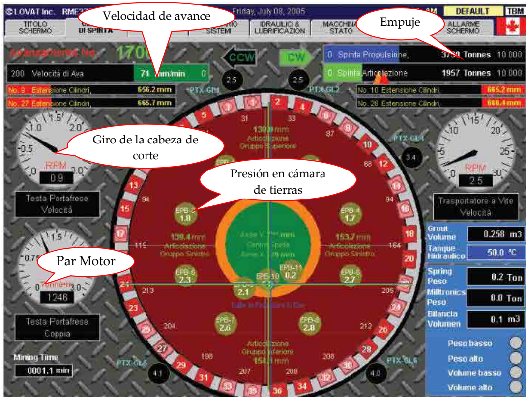
Figura 3.25: Vista del monitor de control de una EPB (Vittorio, 2012)
