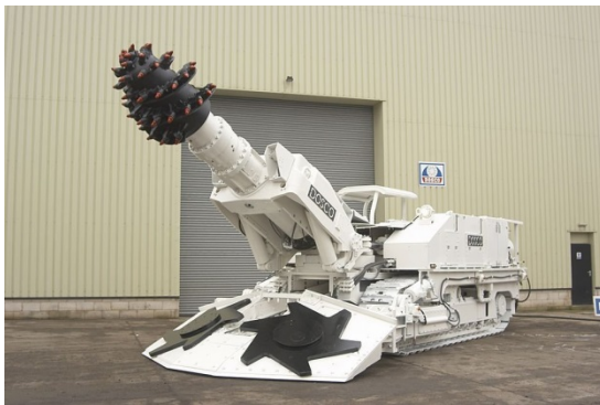
Figura 2.9. a: Cabeza de corte axial (Milling)
