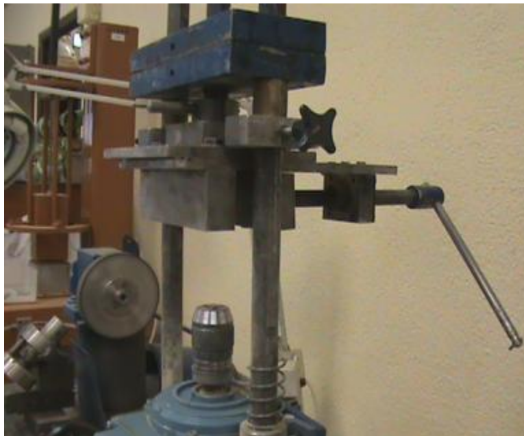
Foto 16: Marco regulable de amarre de la muestra a ensayar, amarrado mediante mordazas.
