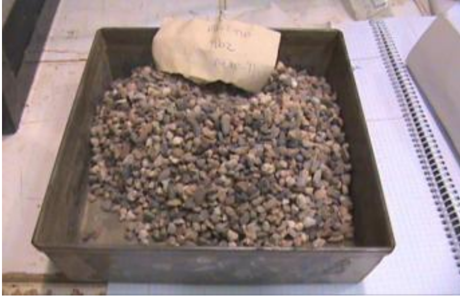
Foto 11: Muestra de Qb2 limpia, seca y tamizada.
