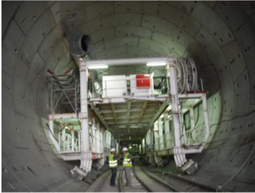
Figura 2.18. Vista del remolque posterior del escudo empleado en el túnel de L9, en Barcelona: Foto de la autora.
