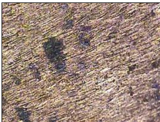
Figura 15. Imagen de la zona sometida a análisis observada con el microscopio electrónico. Las zonas oscuras muestran alteraciones y son indicativas de que se debe seguir puliendo su superficie.
