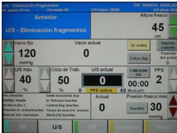
Figura 6: Programa previo a la microincisión bimanual, fase de eliminación de fragmentos. A recordar: vacío máximo de 120 mmHg, potencia de US 40%, altura del frasco 45 cm y presión 30 mmHg.
