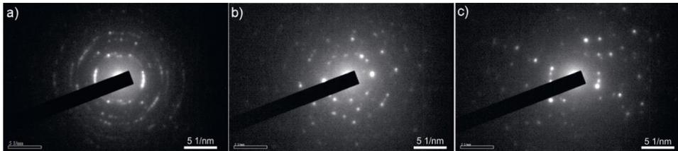
Figura 5.30 Patrones de difracción de electrones obtenidos en la fase de incubación (a), en la *zona de crecimiento* (b) y en la *interfaz zona de crecimiento/superficie* (c) de la capa de AZO depositada con una fracción de  $Al_2O_3$  de 1wt%
