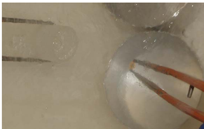
Figura 7. Transferencia de una Planchette con muestra a un criotubo que contiene el medio de FS.
