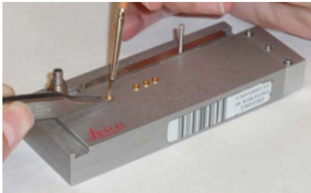
Figura 2. Montaje de una muestra de cultivo en medio sólido en una planchette.
