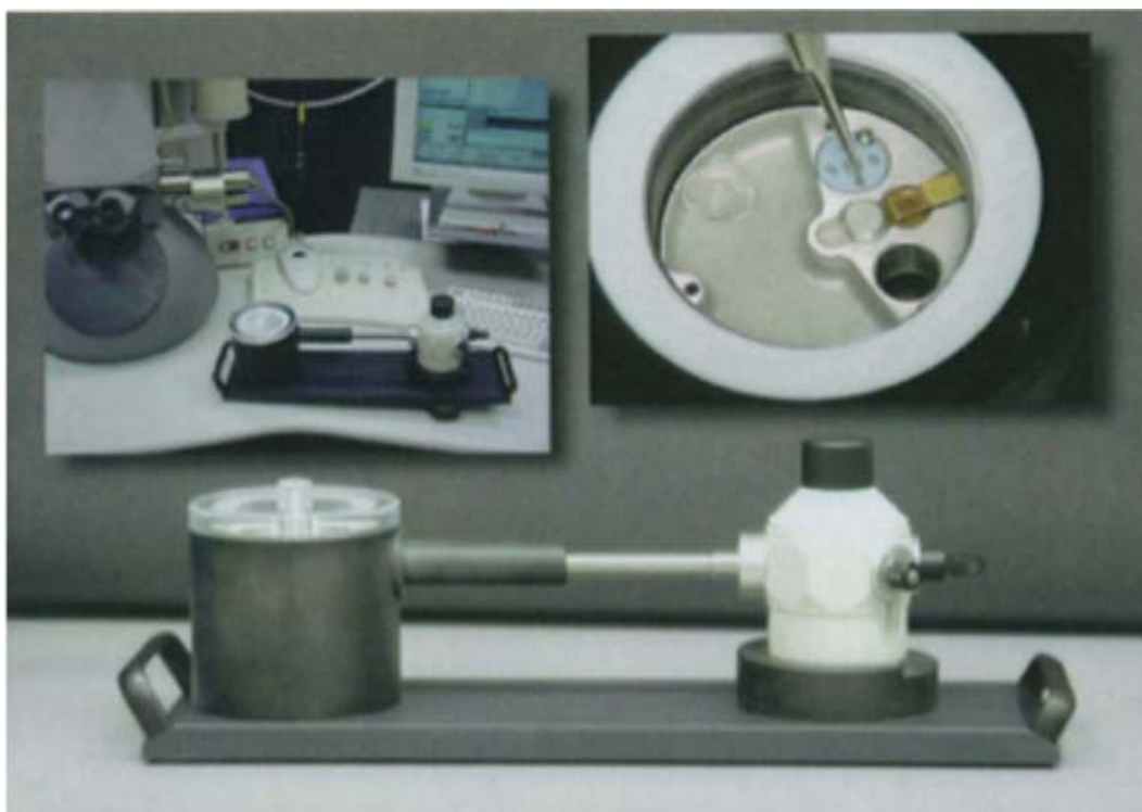
Figura 21. “Cryo-holder” de GATAN en su soporte. Arriba a la derecha se puede observar la cavidad del soporte que se rellena de LN 2 , el rejillero con las rejillas preparadas (azul) y la punta del “cryo-holder” dónde se carga la rejilla.
