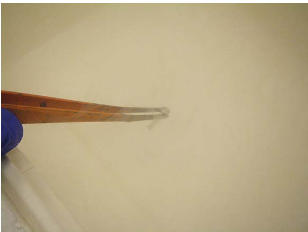
Figura 12. Congelación de un Pin que contiene una muestra por inmersión en LN 2 .
