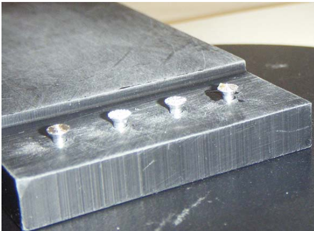
Figura 11. Soportes Pins en la plataforma de montaje (Leica). En el Pin situado más a la derecha se observa un fragmento de muestra ya montado en una zona lateral de la superficie circular.
