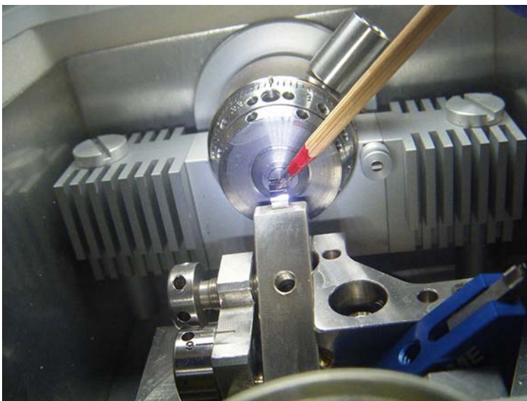
Figura 17. Criocámara del UC6 de Leica preparada para la obtención de VIS. Se observa el acercamiento del pelo (punta del palo de madera) al filo de la cuchilla de diamante.
