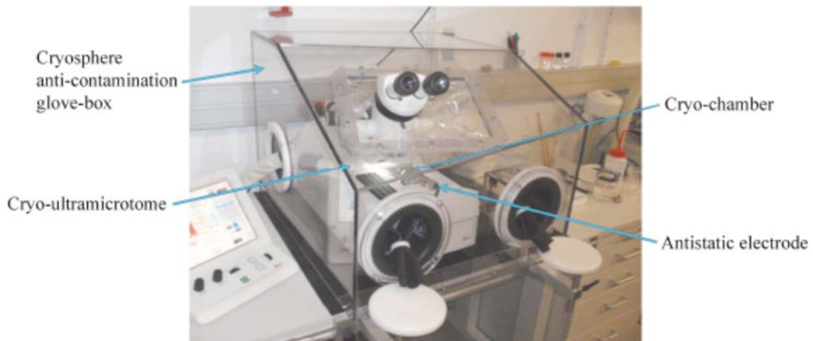
Figura 14. Ultramicrotomo UC6 montado para crioultramicrotomía (criocámara FC6) de VIS con la “cryo-box” (“Cryo-sphere anti-contamination glove-box”).
