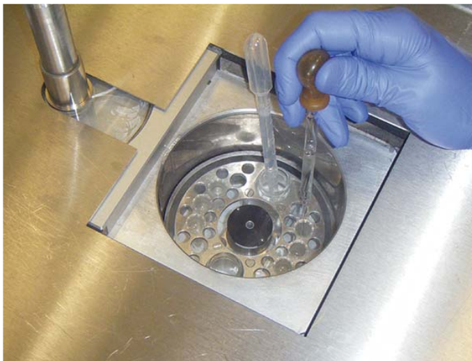
Figura 8. Cambio de soluciones en el interior de la criocámara del AFS de Leica.
