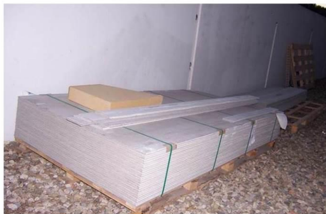
Img.B.47 Placas de 1.20 x 2.40 y 12.5mm de espesor de (CB) Aquapanel de Knauf , hoja exterior de la (FVL) (D)
