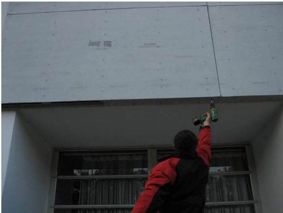
Img.B.42 Ensayo 2 -Febrero 09 de 2011- medida 2 de la configuración (Fb-2) (cámara 25% ventilada) momento de apertura de la cámara para la realización del ensayo (D)
