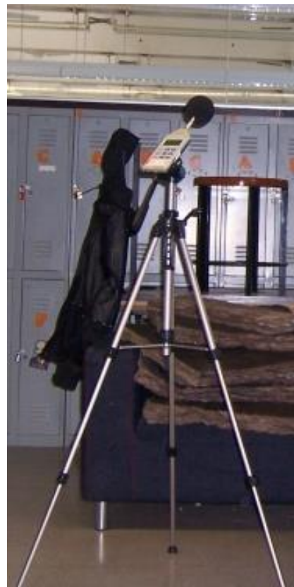
Img.B.25 Imagen del sonómetro de medición. Situado al interior de la sala (D)
