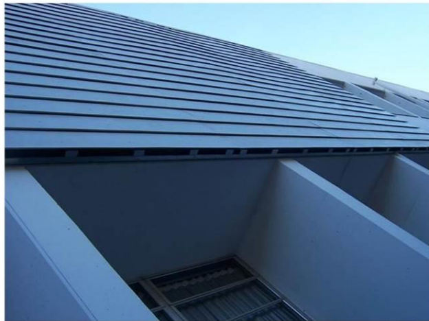
Img.B.39 Ensayo 1 -Febrero 04 de 2011- medida 5 de la configuración (Fd-5) (cámara 100% ventilada) vista inferior (D)
