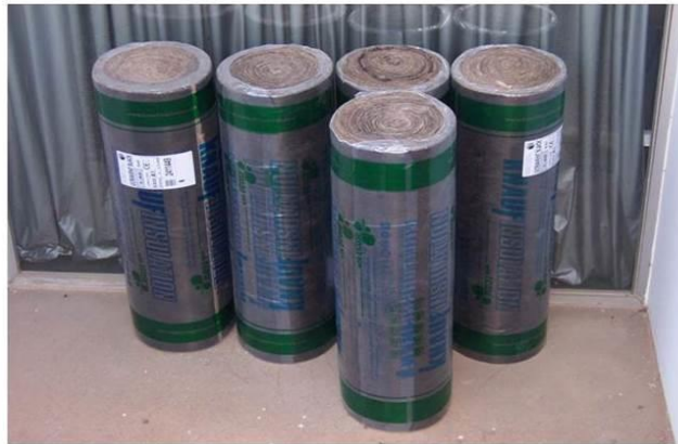
Img.B.46 Lana de roca Ultravent black de Knauf insulation rollo. 40mm de espesor aislamiento de la cámara de la (FVL) (D)
