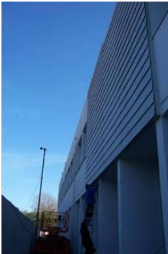
Img.B.24 Ubicación del micrófono. Localización a 2m para la realización de las mediciones exteriores. En este caso para la (FVL) (Fd) con lamas (D)
