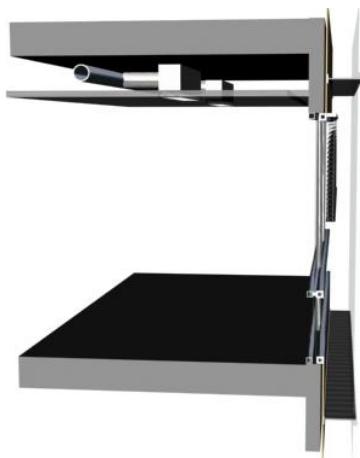
Fig.3.14 Esquema sección de la doble fachada de cristal. Compuesta por: hoja interior de doble cristal 8-12-6mm, hoja exterior de cristal sencillo 6mm y una cámara de 130cm (B11)
