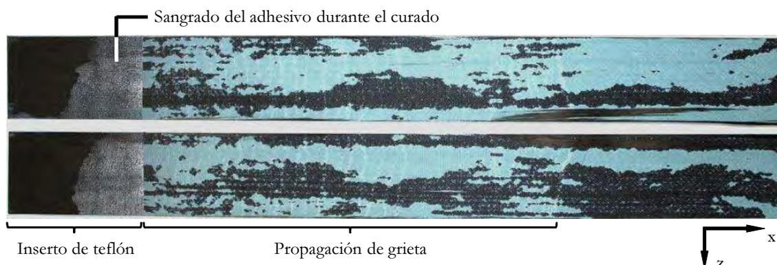
Figura D.2: Puntos analizados de la superficie fracturada.
