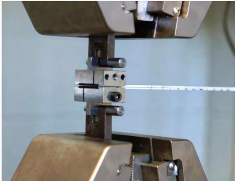
Figura 4.9: Ejemplo del montaje de los utillajes y la probeta en la máquina de ensayo.
