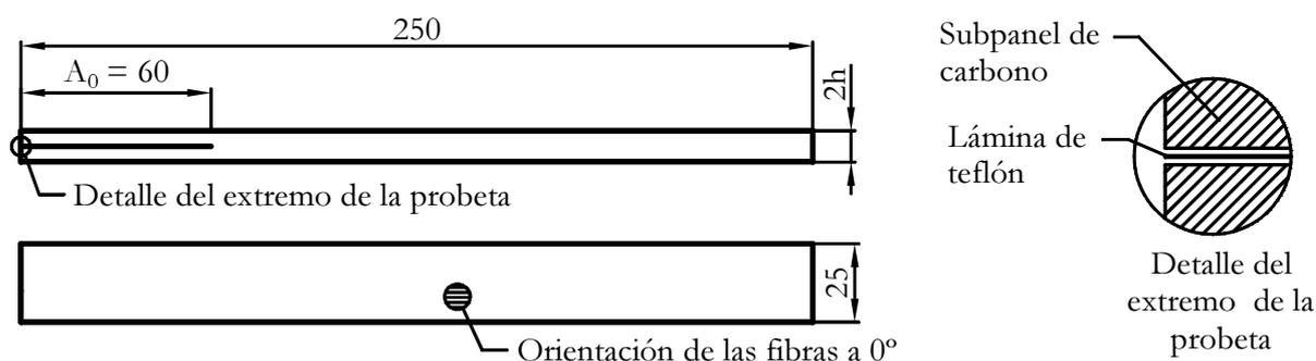
Figura 3.4: Dimensiones de las probetas para ensayos DCB, dimensiones en mm.
