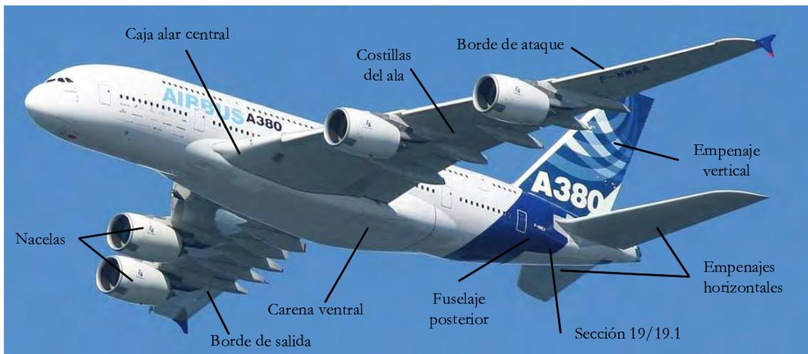
Figura 1.1: Componentes de composite fabricados con fibra de carbono y resina epoxy (CFRP) del modelo Airbus A380.
