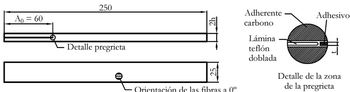
Figura 3.5: Dimensiones de las probetas para ensayos DCB de uniones adhesivas, dimensiones en mm.
