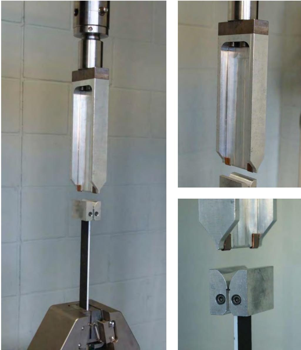
Figura 7.6: Montaje experimental del ensayo de propagación de grieta por avance forzado de cuña (WDT).
