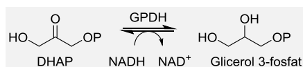
Figura 5.10. Esquema de l'assaig per a la determinació de la concentració de DHAP.
