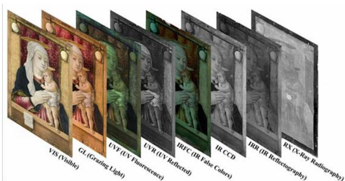
Figura 5.15. Imaging. Les imatges multispectrals permeten examinar una pintura en diferents rangs de longituds d'ona electromagnètiques. La figura mostra diversos tipus de llum, com visible, infraroig, ultraviolat i raigs X. Cada tipus d'imatges multispectrals revela informació en particular sobre la base de cada mètode. Imatge: Credit: WebExhibits Omi Omiti.
