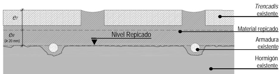
Figura B.1: Esquema del espesor del repicado
