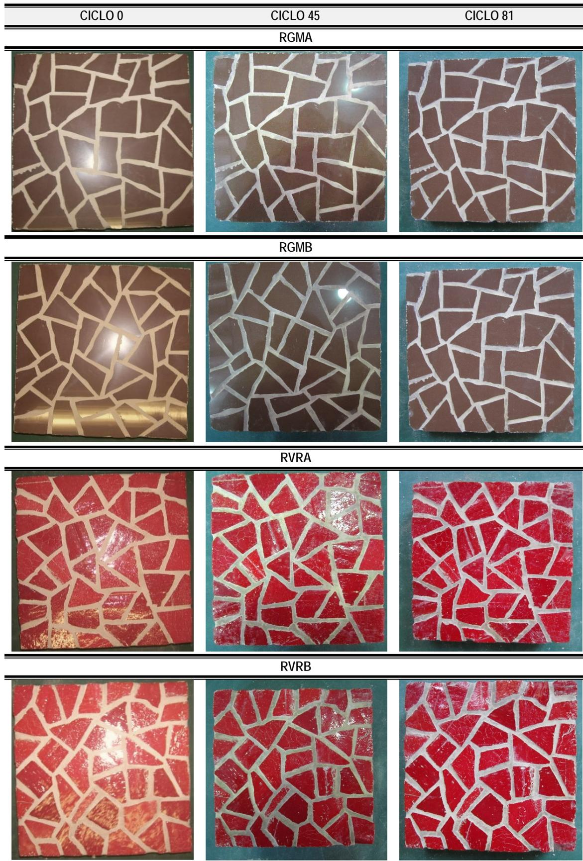
Tabla C7: Probetas de restauración sometidas a ciclos de mojado/secado (RGMA; RGMB; RVRA; RVRB)
