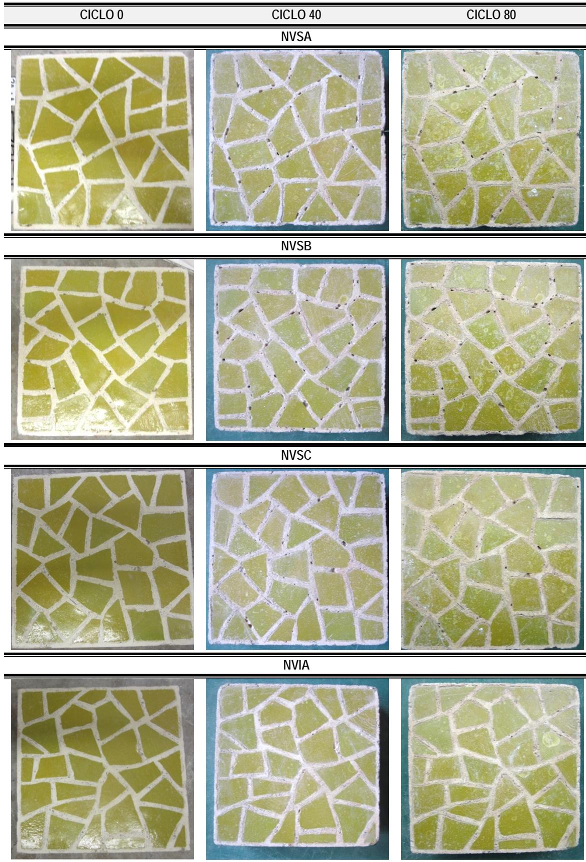
Tabla C8: Probetas de obra nueva sometidas a ciclos de choque térmico (NVSA; NVSB; NVSC; NVIA)
