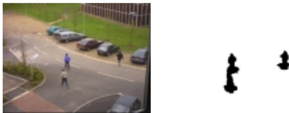
**Figura 5.11:** Error del método de localización debido a la perspectiva de la escena.
