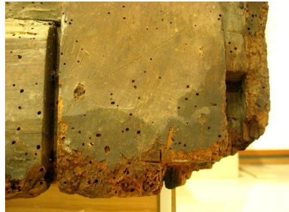
Figura 3.42. Taula de la vida de Jesús_3747_cantonada inferior dreta_degradació per atac de xilògens, desgast i humitats per capil·laritat. (© BAUTISTA, I.)
