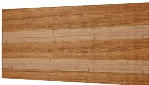
Figura 4.463. Plafó central format per quatre posts horitzontals unides amb espigues metàl·liques. Visió P2 i P4 amb el 50% de transparència.
