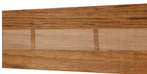
Figura 4.8. Plafó central i barrots travessers al revers. Visió P2 amb el 50% de transparència. (© BAUTISTA, I.)
