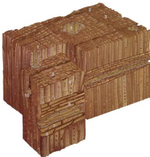
Figura 3.4. Estructura microscòpica de la fusta de coníferes. (© GARCIA, GUINDEO; PERAZA, PALACIOS 2003:52)
