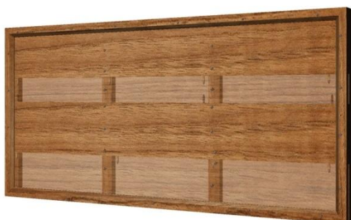
Figura 4.447. Plafó central, barrots travessers al revers i muntants del marc a l'anvers. Visió P2 i P4 amb el 50% de transparència. (© BAUTISTA, I.)
