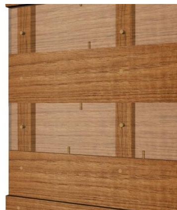
Figura 4.131. Detall de les espigues de fusta que uneixen les posts del plafó central, els muntants del marc horitzontals amb el plafó i els travessers al plafó pel revers. Visió P1 i P3 amb el 50% de transparència. (© BAUTISTA, I.)
