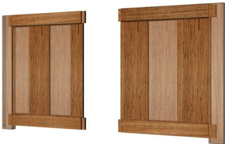
Figura 4.96. Plafó central i muntants del marc encadellats. Visió P1 i P3, i P2, i muntants del marc vertical amb el 50% de transparència. (© BAUTISTA, I.)
