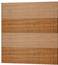
Figura 4.128. Plafó central format per quatre posts horitzontals. Visió P1 i P3 amb el 50% de transparència. (© BAUTISTA, I.)
