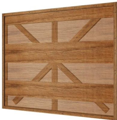
Figura 4.484. Plafó central, barrots travessers i muntants del marc a l'anvers. Visió P2, P4 i P6 amb el 50% de transparència. (© BAUTISTA, I.)
