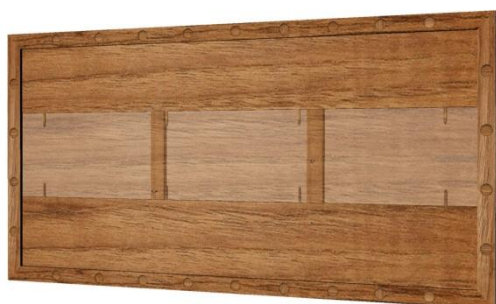
Figura 4.409. Plafó central, barrots travessers verticals al revers i muntants del marc a l'anvers. Visió P2 amb el 50% de transparència. (© BAUTISTA, I.)
