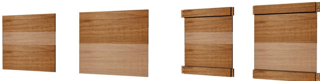
Figura 4.74. Plafó central format per tres i dos posts horitzontals. Visió P2 amb el 50% de transparència. (© BAUTISTA, I.)
