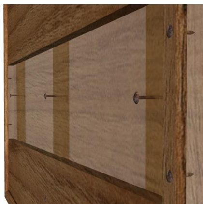
Figura 4.366. Detall dels claus de forja reblats que uneixen els muntants del marc i els barrots travessers verticals al plafó central, des de l'anvers cap al revers. Visió P2 i barrots travessers verticals del revers amb el 50% de transparència. (© BAUTISTA, I.)
