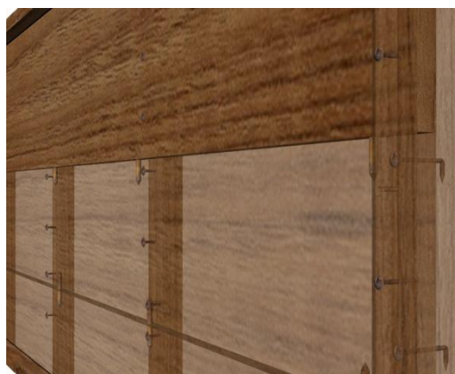
Figura 4.448. Detall dels claus de forja reblats que uneixen els muntants del marc i els barrots travessers des de l'anvers al revers. Visió P3, P4, M4 i T1 amb el 50% de transparència. (© BAUTISTA, I.)
