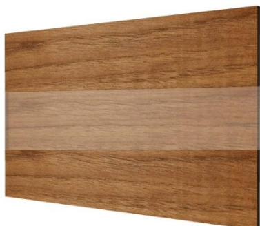
Figura 4.363. Plafó central format per tres posts horitzontals. Visió P2 amb el 50% de transparència. (© BAUTISTA, I.)
