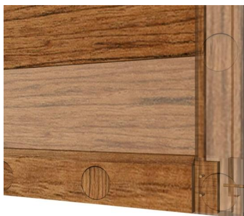
Figura 4.183. Detall de l'encaix a caixa i espiga dels muntants del marc. Visió P4, i muntant del marc vertical amb el 50% de transparència. (© BAUTISTA, I.)
