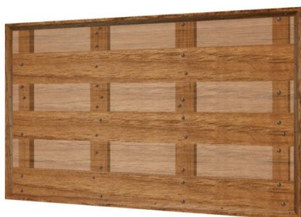
Figura 4.204. Plafó central, barrots travessers al revers i muntants del marc a l'anvers. Visió P1, P3 i P5 amb el 50% de transparència. (© BAUTISTA, I.)
