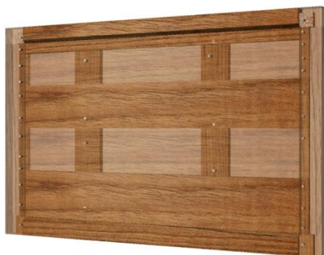
Figura 4.387. Plafó central, barrots travessers al revers i muntants del marc a l'anvers units a caixa i espiga. Visió P2 i P4, i muntants del marc verticals amb el 50% de transparència. (© BAUTISTA, I.)
