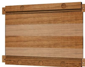
Figura 4.23. Plafó central i muntants horitzontals del marc. Visió P2 i P4 amb el 50% de transparència.
