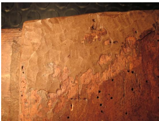
Figura 3.75. Taula de Toses _35700_ Reintegració del muntant vertical amb pasta de fusta. (© BAUTISTA, I.)
