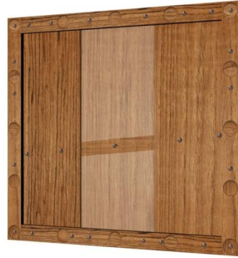
Figura 4.282. Plafó central, muntants del marc a l'anvers i barrot travesser al revers. Visió P2 amb el 50% de transparència. (© BAUTISTA, I.)
