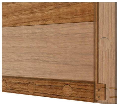
Figura 4.57. Detall de l'encaix a caixa i espiga dels muntants del marc. Visió P2 i M4 amb el 50% de transparència. (© BAUTISTA, I.)
