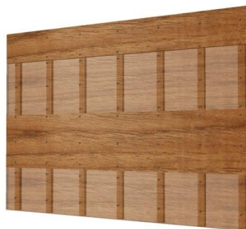
Figura 4.424. Plafó central i barrots travessers al revers. Visió P2 i P4 amb el 50% de transparència. (© BAUTISTA, I.)
