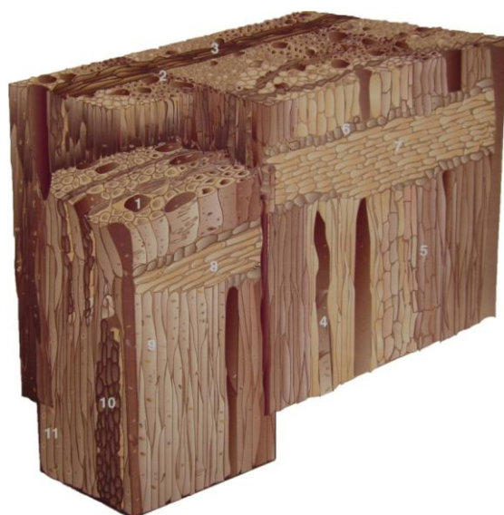
Figura 3.17. Estructura microscòpica de la fusta de frondosa. (© GARCIA, GUINDEO; PERAZA, PALACIOS 2003:74)
