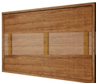
Figura 4.365. Plafó central, barrots travessers verticals al revers i muntants del marc a l'anvers. Visió P2 amb el 50% de transparència. (© BAUTISTA, I.)
