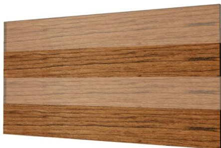
Figura 4.341. Plafó central format per quatre posts horitzontals. Visió P1 i P3 amb el 50% de transparència. (© BAUTISTA, I.)
