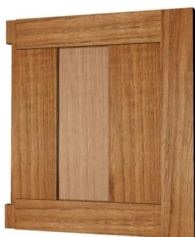
Figura 4.250. Plafó central i muntants del marc encadellats. Visió P2 amb el 50% de transparència. (©BAUTISTA, I.)
