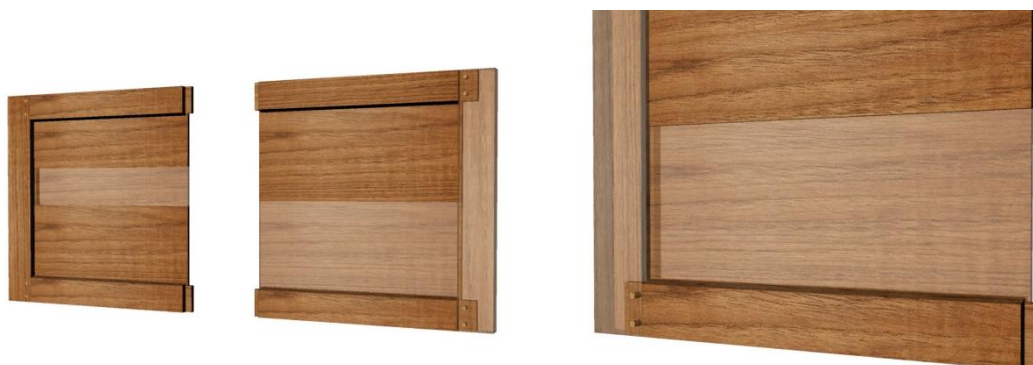
Figura 4.76. Plafó central i muntants del marc encadellats. Visió P2 i muntant del marc vertical amb el 50% de transparència. (© BAUTISTA, I.)
