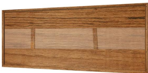
Figura 4.9. Plafó central, barrots travessers al revers i muntants del marc a l'anvers. Visió P2 amb el 50% de transparència. (© BAUTISTA, I.)
