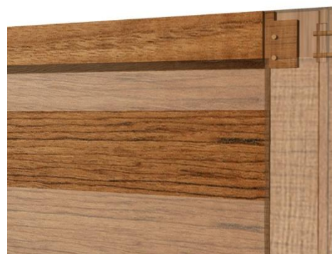
Figura 4.262. Detall de l'encaix a caixa i espiga dels muntants del marc. Visió P1, P3 i muntants del marc verticals encadellats amb el 50% de transparència. (© BAUTISTA, I.)
