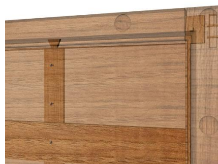
Figura 4.25. Detall de l'encaix a caixa i espiga dels muntants del marc i encaix amb mitja cua d'oronella del barrot travesser. Visió P1, P3, i muntants del marc amb el 50% de transparència. (© BAUTISTA, I.)
