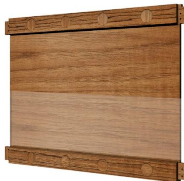
Figura 4.55. Plafó central i muntants horitzontals del marc. Visió P2 amb el 50% de transparència.(© BAUTISTA, I.)
