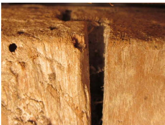
Figura 2.10. Taula de sant Miquel dels Ars_5140_Unió de les posts del plafó central a mitja fusta. (© BAUTISTA, I.)
