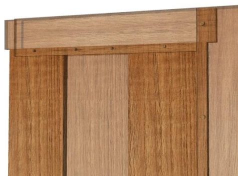
Figura 4.251. Detall de l'encaix a caixa i espiga dels muntants del marc i encaix per encadellat reforçat amb espigues. Visió P2 i muntants del marc amb el 50% de transparència. (©BAUTISTA, I.)
