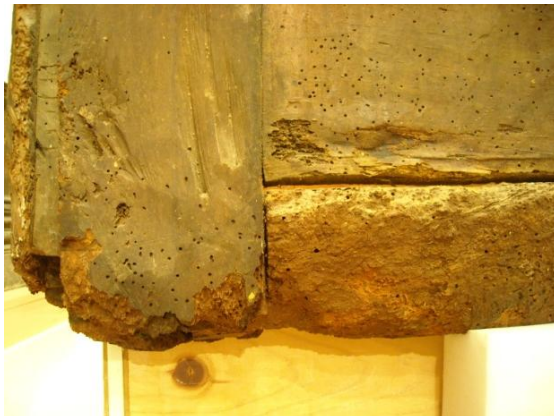
Figura 3.41. Taula de la vida de Jesús_3747_cantonada inferior esquerra_degradació per atac de xilògens, desgast i humitats per capil·laritat. (© BAUTISTA, I.)
