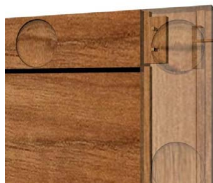
Figura 4.236. Detall de l'encaix a caixa i espiga dels muntants del marc. Visió M4 amb el 50% de transparència. (© BAUTISTA, I.)
