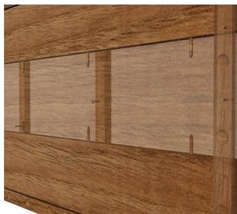
Figura 4.410. Detall dels claus de forja reblats que uneixen els barrots travessers verticals, de l'anvers al revers i de les espigues de fusta que uneixen els muntants del marc al plafó central a l'anvers. Visió P2 i muntants del marc amb el 50% de transparència. (© BAUTISTA, I.)
