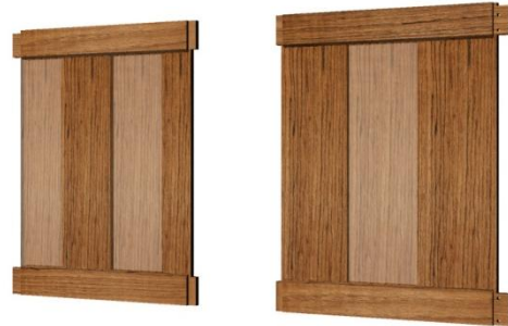
Figura 4.95. Plafó central i muntants horitzontals del marc. Visió P1 i P3, i P2 amb el 50% de transparència. (© BAUTISTA, I.)
