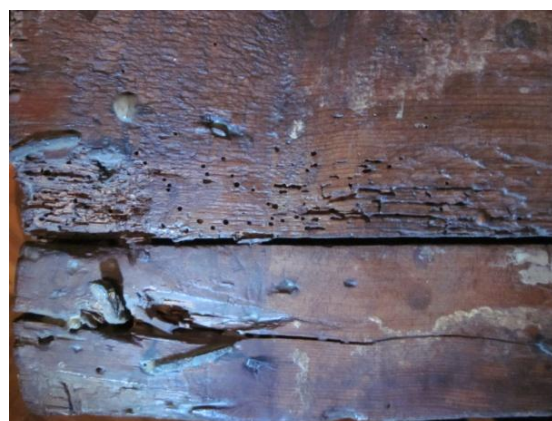
Figura 3.37. Taula de sant Pere_2848_Esquerda a la P1 produïda per un clau de forja. (© BAUTISTA, I.)
