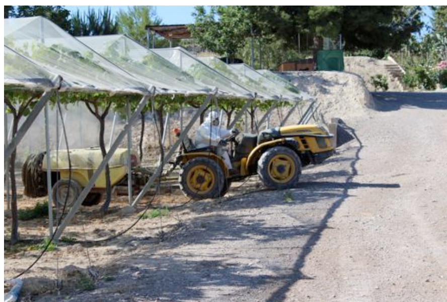
Imagen: Trabajador autónomo con el pequeño y típico “tractor parralero” –el más adecuado para los trabajos en el parral–, y su atomizador, realizando labores de fumigación.
