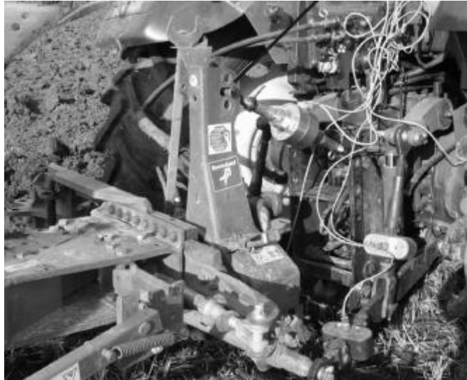
Figura 2.19: Dinamòmetre desenvolupat per Cupera et al. amb un ormeig muntat [27]
