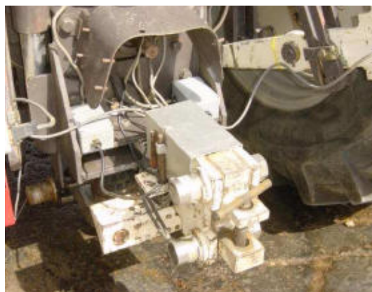
Figura 2.27: Barra de tir dinamomètrica desenvolupada per Al-Suhaibani i Ghaly [38]
