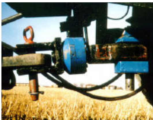
Figura 2.26: Cèl·lula de càrrega instal·lada entre tractor i remolc per a la mesura de la força de tracció utilitzada per Turner [28]
