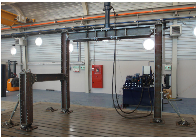
Figura 6.5: Bancada per a assajos estructurals
