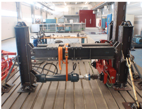
Figura 6.11: Assaig de força longitudinal en l'ancoratge inferior dret
