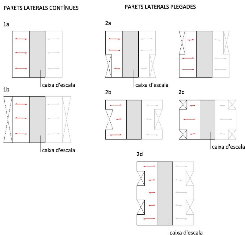
Figura 41: Modificació de la tipologia amb escala lateral
