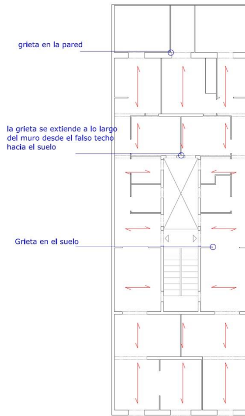
Figura 269: Ubicació en planta de les principals esquerdes
