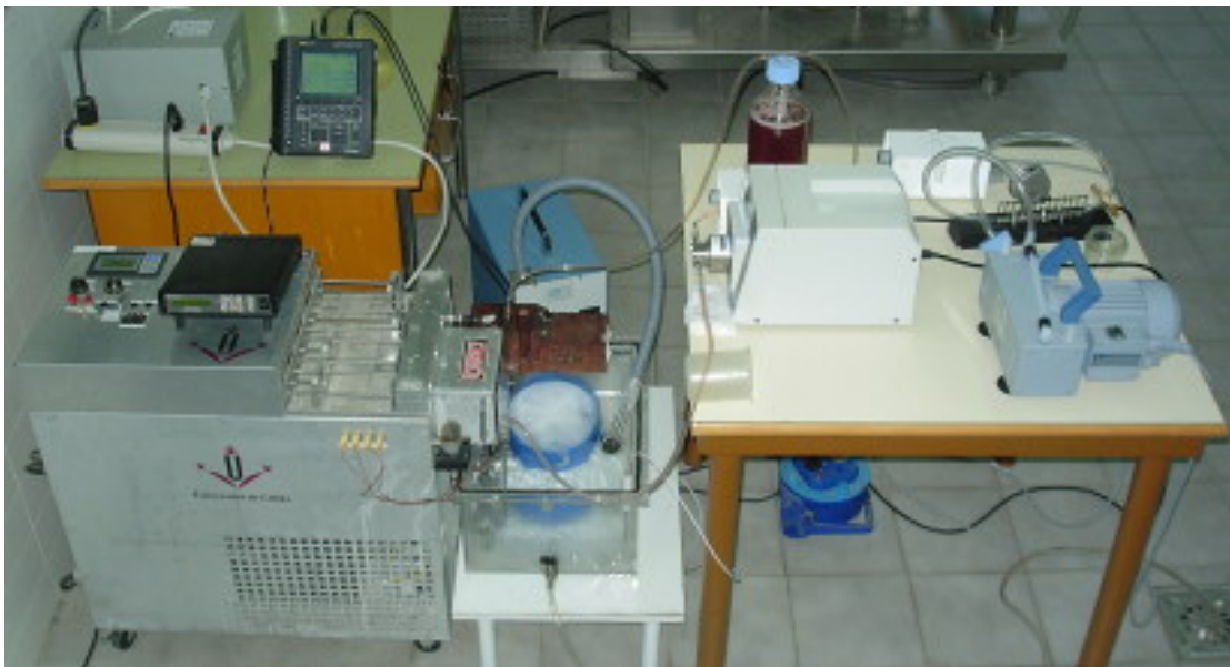
Figura 3.1: Vista general del equipo de procesamiento mediante PEAIC.
