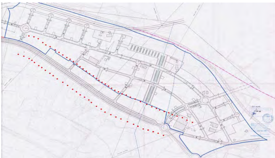
Figures 8.81 i 8.82. Perspectiva i planta de la carretera-mercat de l’entrada sud per la N-II a Girona (Fornells de la Selva). Es tracta d’una zona amb una forta especialització en el ram dels concessionaris d’automoció. Observi’s, al plànol inferior, com el sector històric (puntejat en roig al voltant de la carretera) ha anat essent ampliat per noves actuacions; en aquest cas el PP Pla de la Seva (2002). Font: Juli Valdunciel i RPUC.
