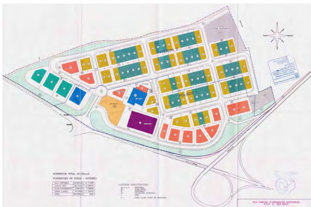
Figura 8.66. PP SUP-2 Els Recs (L'Escalà). Observi's la concepció funcional de l'espai: un accés general dóna pas a un vial flanquejat per illes amb parcel·les per a empreses entre mitgeres (més petites), combinades amb unes poques bateries de parcel·les per a empreses aïllades, ubicades, estratègicament, a la façana principal del sector. Font: RPUC.
