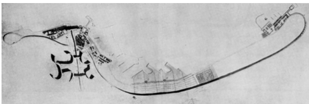
IC18: Projecte "A" d'urbanització de la ciutat d'Argel - Planta La infraestructura ressegueix la cornisa per connectar els dos barris limítrofs i contenir el programa residencial.
