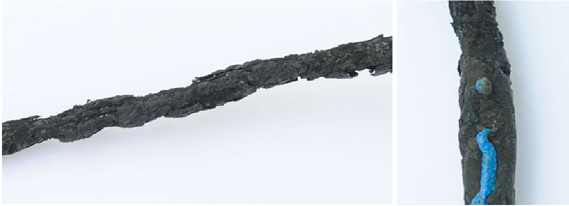
Fig.1.9 Conductor de coure aïllat afectat pel foc. (A.f. Martí, M.)
