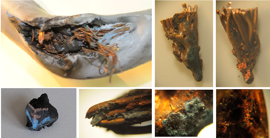
Fig.1.25 Cable multipolar de BT afectat per curtcircuit i arc elèctric. (A.f. Martí, M.).
