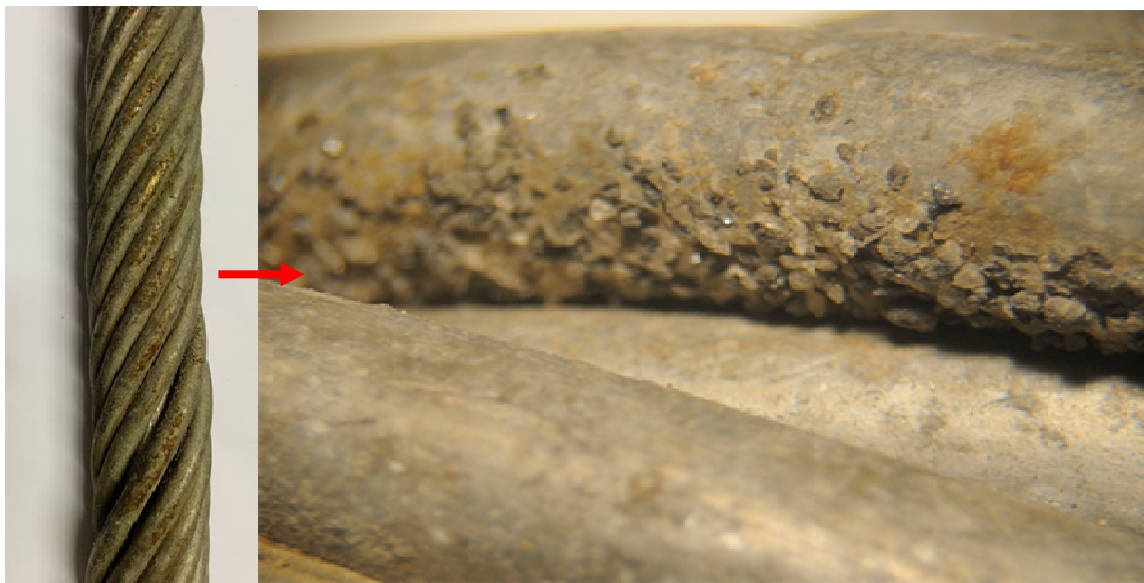
Fig.1.23. Partícules adherides a una empiuladura de Al sotmesa a l'acció de l'arc. (A.f. Martí, M.).
