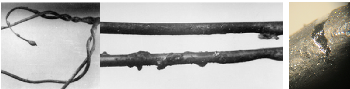
Fig.1.28 (a) Rastres de fusió del coure de conductors produïts per incendis. (A.f. NFPA 921. Font: v. [22]). (b) Rastres de fusió en un conductor d'alumini produït per una torxa de butà. (A.f. Martí, M.).
