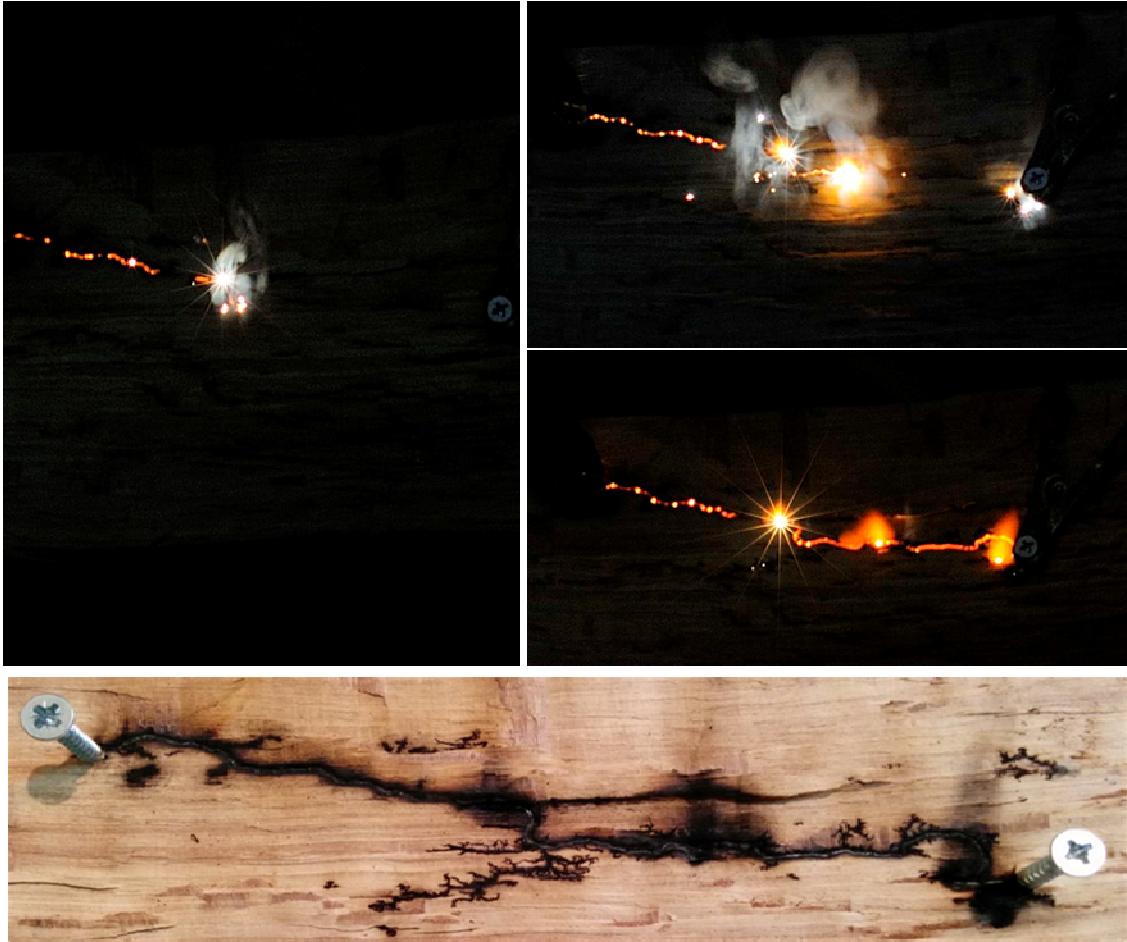
Fig.1.19 Descàrregues sobre camins conductors carbonitzats en un tronc humit. (A.f. Martí, M.).
