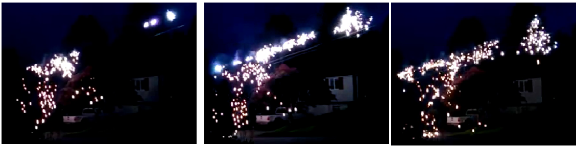
Fig.1.34 Ejecció d'espurnes des d'una línia aèria ocasionada per l'acció de l'arc. (A.f.d. Font: v.[78]).
