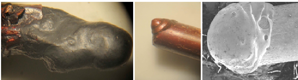
Fig.1.24 (a) Extrem d'un conductor de Cu sotmès a curtcircuit i arc de separació. (b) Extrem d'un conductor de Cu sotmès a arcs usant un soldador a l'arc. (A.f. Martí, M). (c) Detall de l'extrem d'un conductor de Cu sotmès a arcs usant un soldador a l'arc. (Bosch, R., Marsal, M.).
