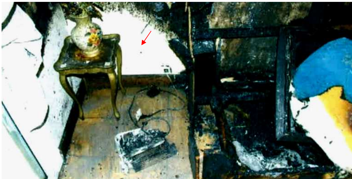
Fig.1.2 Escena d'un incendi provocat per un calefactor elèctric. (A.f.d. Font: v. [7]).
