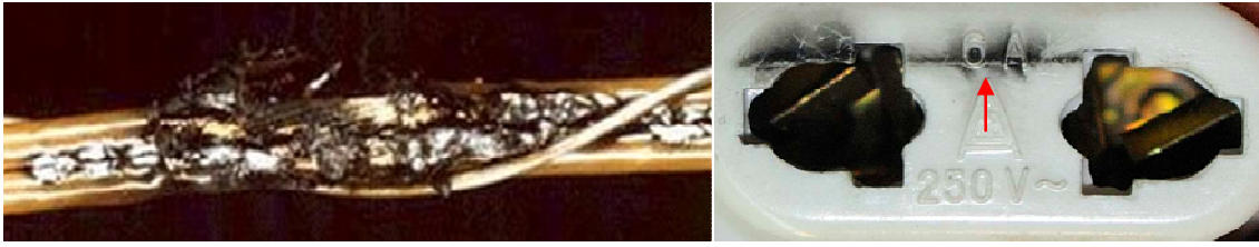
Fig.1.32 (a) Cable sotmès a un assaig de resistència a l'arc per pistes carbonitzades. (A.f.d. Font: [67]). (b) Pista carbonitzada entre els forats d'un adaptador d'endoll Schuko a americà. (A.f. Bosch, R., Martí, M.)
