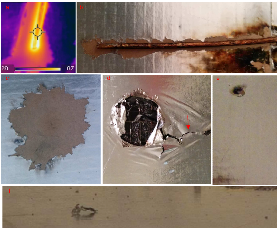
a: Anàlisi termogràfic dels elèctrodes un cop finalitzat un assaig amb la configuració D. b: Elèctrode de coure rígid i superfície del panell un cop finalitzat un assaig amb la configuració D. c: Superfície del panell un cop finalitzat un assaig amb la configuració E (corrent de curtcircuit de cresta fort, \approx 4 kA, sense flama). d: Superfície del panell un cop finalitzat un assaig amb la configuració E (corrent de curtcircuit de cresta fort, \approx 3 kA, s'estableix flama sobre el panell). e: Superfície del panell un cop finalitzat un assaig amb la configuració E (petit corrent de curtcircuit de cresta \approx 300 A). f: Partícules i cendres d'alumini, procedents de la pluja d'espumes, dipositades sobre el panell després de l'assaig.
