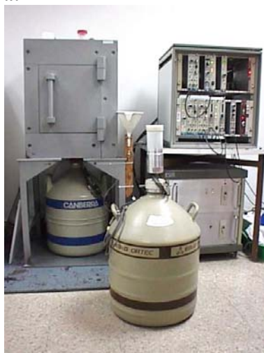
Figura 4.21. a. Sistema d'espectrometria gamma (GM3 detector de pou) . b. Espectre típic de l'anàlisi gamma d'una mostra de sediment.
