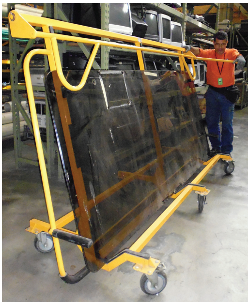
Imagen 69. ZULUAGA G, Gladys. Carro para transportar los parabrisas de los vagones del Metro de Medellín movido por un operario [Fotografía] Bello: Talleres del Metro, Agosto 21 de 2013
