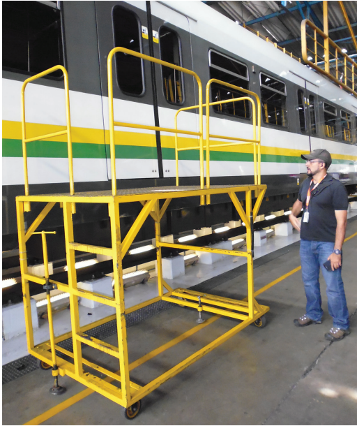
Imagen 68. ZULUAGA G, Gladys. Plataforma que complementa el Carro para transportar los parabrisas de los vagones del Metro de Medellín [Fotografía] Bello: Talleres del Metro, Agosto 21 de 2013
