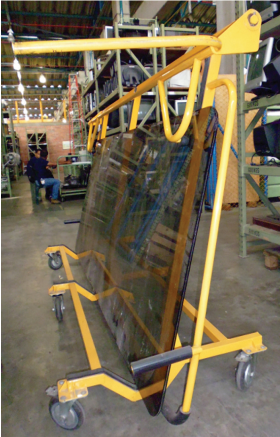
Imagen 67. ZULUAGA G, Gladys. Carro para transportar los parabrisas de los vagones del Metro de Medellín [Fotografía] Bello: Talleres del Metro, Agosto 21 de 2013
