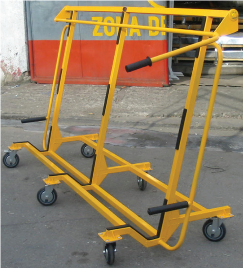
Imagen 66. VELEZ J, Alejandro. Carro para transportar los parabrisas de los vagones del Metro de Medellín. [Fotografía]. Medellín, 2003
