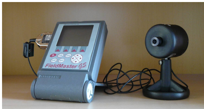
Figura 8. Equip de mesura de la potència d'emissió làser emprat: High Sensitivity Thermal Sensor connectat a un Coherent® FieldMaster/GS.
