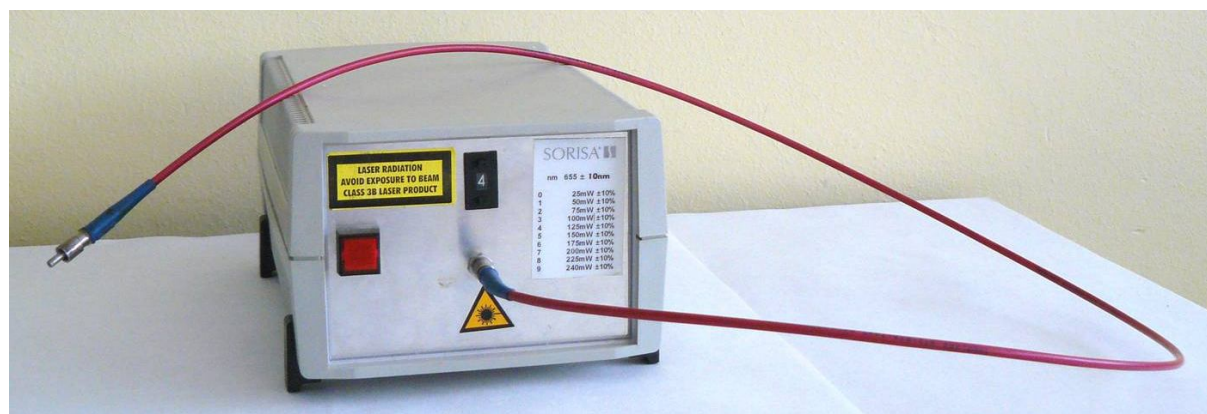
Figura 7. Làser de díode d'emissió contínua de 655 nm de longitud d'ona de potència de sortida variable mesurada de 5 – 53 mW i un spot de 0.56 cm 2 (SORISA, Barcelona) emprat en la present recerca.
