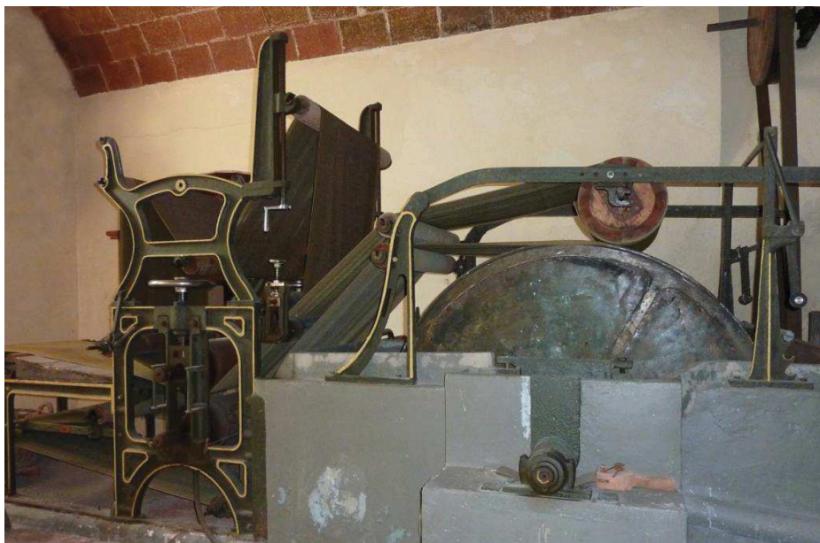
61. Màquina sistema Picardo, en funcionament a la fàbrica Munné fins l'any 1974. Observi's la similitud del seu disseny i dels seus components –tambor, corrons, bancades, baietes, etc.- amb l'esquema de l'any 1877. (imatge 60).
