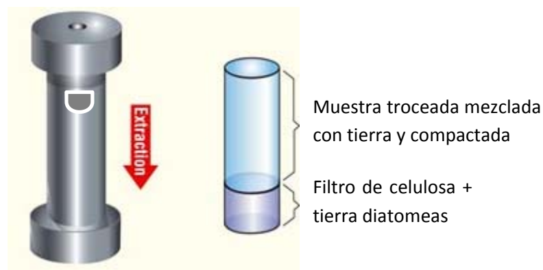
Figura 74. Sentido y montaje de la celda del ASE con la muestra.
