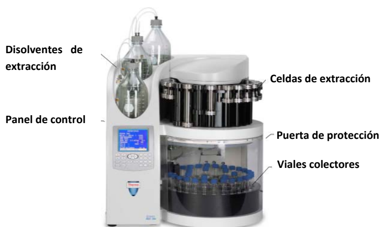
Figura 72. Sistema ASE 350 de Dionex (equipo para realizar la extracción acelerada con disolvente).
