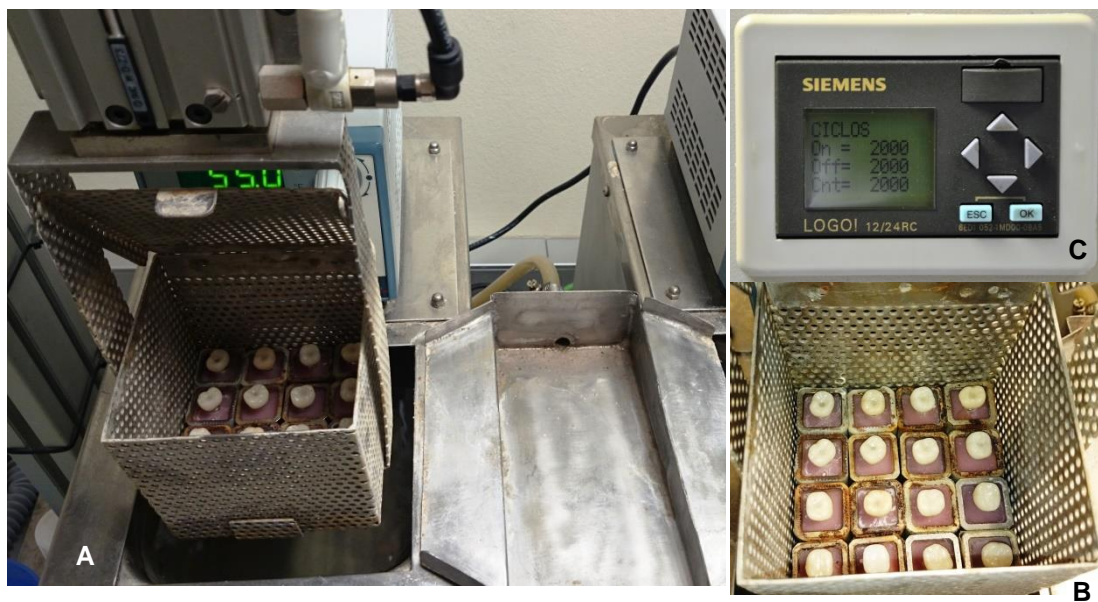
Figura 14: Fotografías en las que se observa la posición de la muestra en la máquina de termociclado(A), dentro del cesto que transporta las muestras (B) y contador de ciclos (C).
