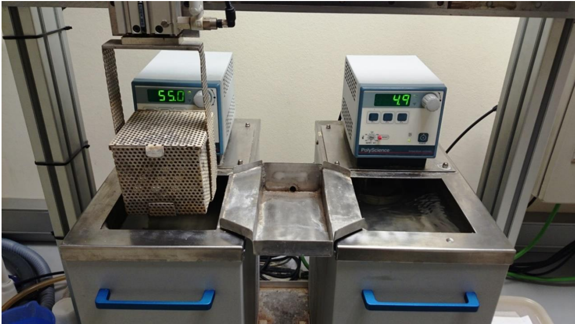
Figura 13: Fotografía de la máquina de termociclado en las instalaciones de la Universitat Internacional de Catalunya.
