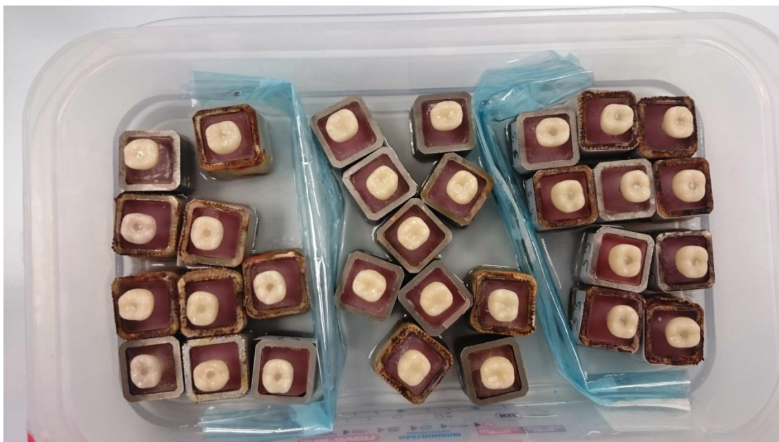
Figura 11: Coronas colocadas en un recipiente con agua en la base tras la cementación.
