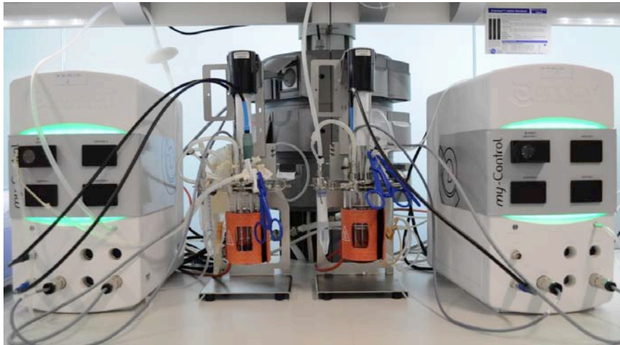
Figura 7–1 Bioreactores miniBio empleados para cultivos de expansión y diferenciación eritroide: En el centro de la imagen se observa los bazos de cultivo equipados y en funcionamiento; y a ambos extremos las unidades de control my-Control .
