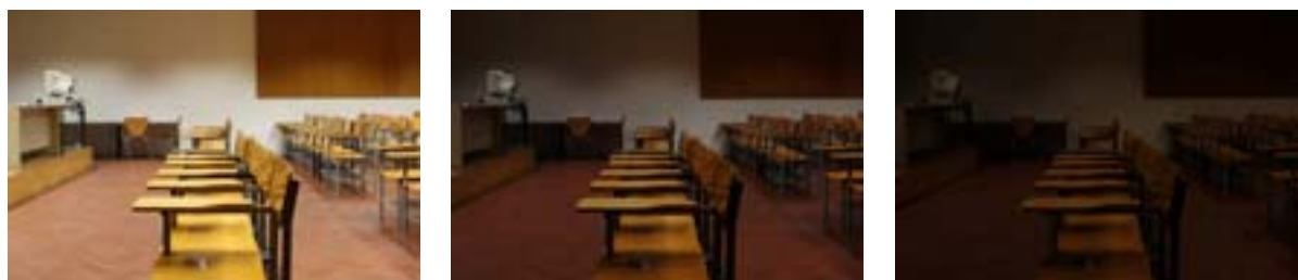
Figura A_I.03: Fotografies de les tres escenes lumíniques de l'experiment de Barcelona, amb valors promitjos d'il·luminància de 530, 7,5 i 1 lux a la superfície de treball.
