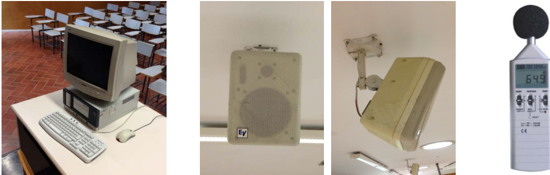
Figures A_I.22-25: Fotografies dels aparells utilitzats per reproduir i mesurar els estímuls acústics durant el transcurs dels experiments: PC, altaveus i sonòmetre.
