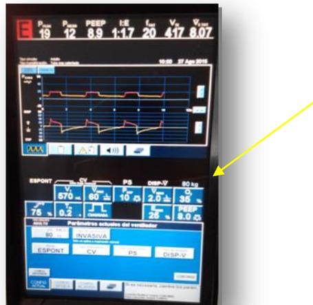
**Figura 11.** Fotografía de la pantalla del respirador Puritan Bennet P840. La flecha indica el control de FiO<sub>2</sub>
