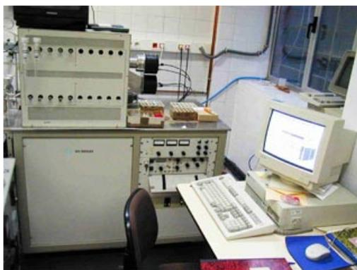
Figura 40. Espectrómetro de masas “Dual Inlet”, modelo SIRA-II (Fuente: <http://campus.usal.es/~isotopos/>).
