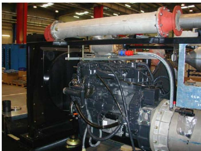
Figura 2.9. Motor de combustión interna marca Fiat de 120 kW<sub>e</sub>.
