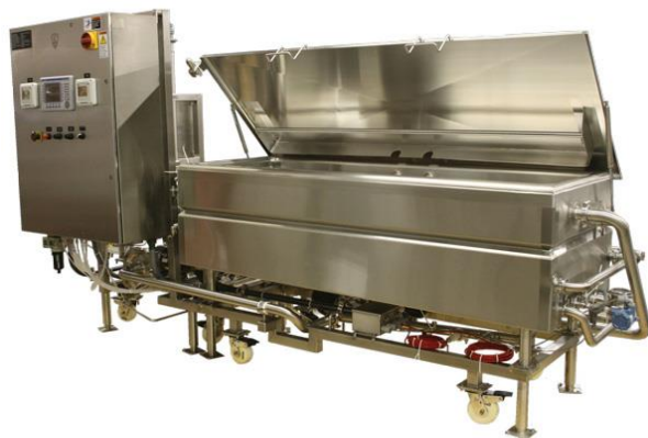
Figura 6: Ejemplo de sistema farmacéutico de COP, lavado por inmersión de piezas (Sani-Matic, Inc2012).
