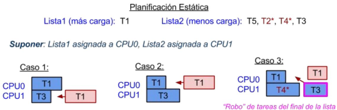
**Figura 4.14:** planificación usando dos listas estáticas de tareas y usando un mecanismo de compensación para amortiguar el efecto de las diferencias en el tiempo de ejecución respecto a la predicción estática.
