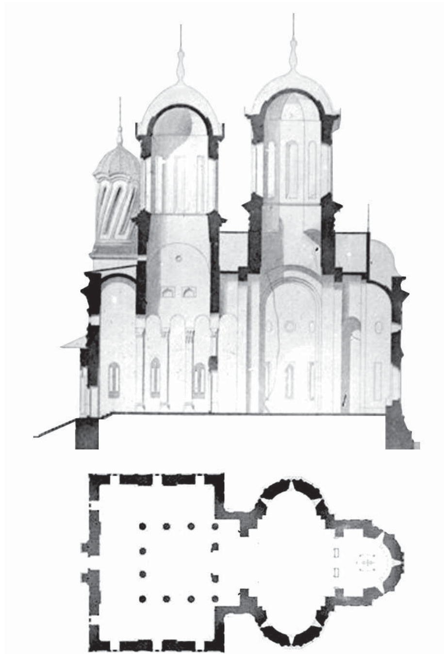
Secció longitudinal i planta de l'església. Imatge: Arxiu biblioteca escola d'arquitectura "Ion Mincu"
