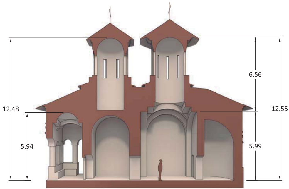
Secció longitudinal fugada 1:200 0 5 m
