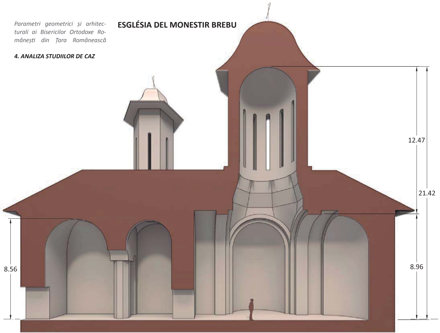
Secció longitudinal fugada 1:200 0 5 m
