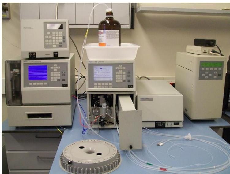
**Figura 27.** Equipo de cromatografía líquida de alta eficacia (HPLC).
