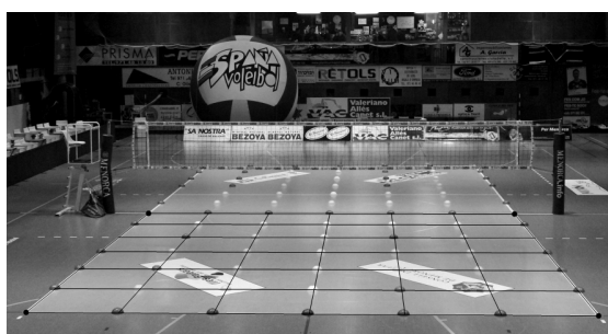
Figura 5.1. Cuadrícula de perspectiva del software Kinovea v. 0.8.17 dibujada sobre un sistema de referencias espacial formado por 49 puntos de referencia separados entre sí 1.5 m.
