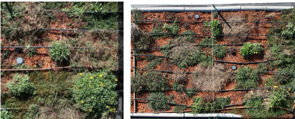
Fig. 7 Medición de la cobertura y de la biodiversidad en las dos cubiertas
