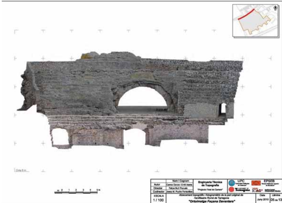
Fig.8. Alçat obtingut d'un model 3D. Amfiteatre de Tarragona
