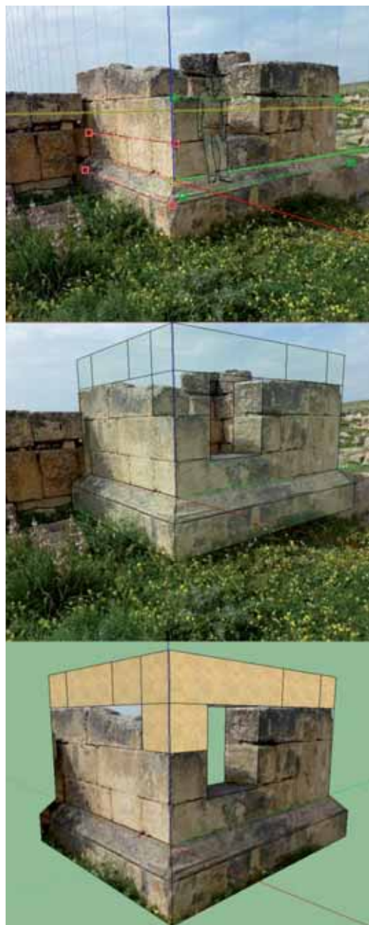
Fig.4. Model fotogramètric 3D obtingut a amb l'Sketch Up
