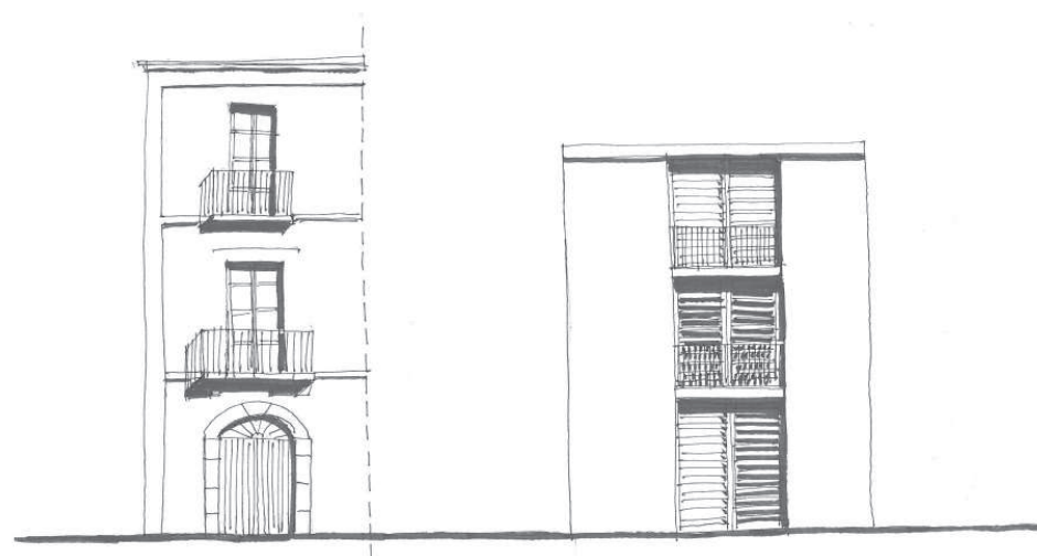
La façana de Can Zendrera amb l'esquema compositiu clàssic, al costat l'evolució de l'esquema proposat per Harnden i Bombelli
