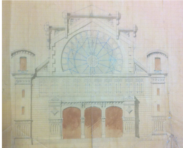
Fig. IV.LXXXV. Alzado de fachada principal de la nave central del Palacio de la Industria y el Comercio, lápiz y acuarela, escala 1:50, s/r., s/f. (José Doménech y Estapà, junio-julio de 1887) [ACOACB: Fons Doménech Estapà/Doménech Mansana, H106N/10/5].
