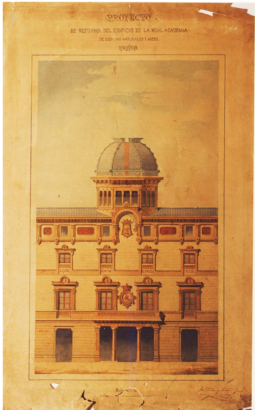
Fig. IV.XXV. Alzado de la reforma de la fachada principal de la Real Academia de Ciencias Naturales y Artes de Barcelona, esc.1:50, José Doménech y Estapá, 25 de junio de 1883 [ARACAB, Doc.: 324.14; Cpt.: Obres d'Arranjament; Sig. Top.: 3.4.4.; Caja 324.13-324.15]. Copia en acuarela publicada en PUIG-PEY SAURÍ, J. (2014), Op. cit., p.160.
