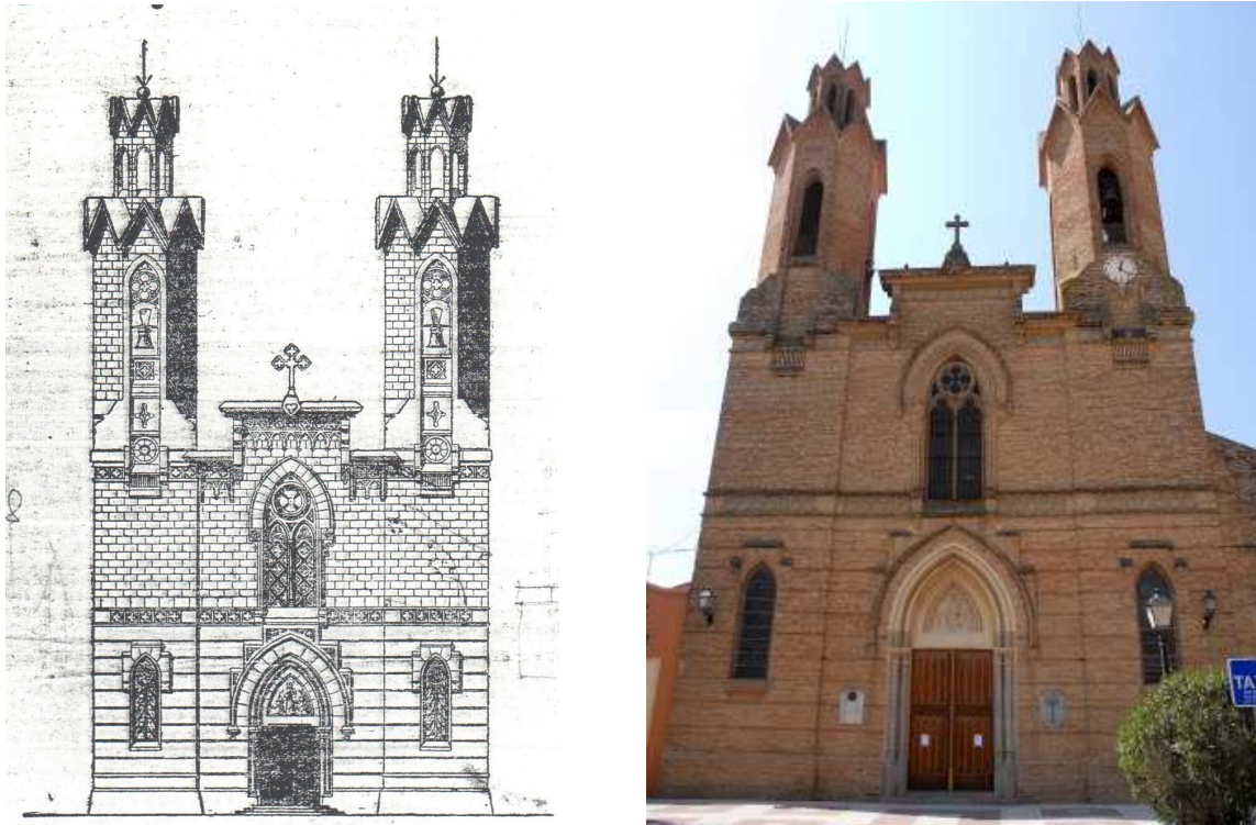
Figs. IV.XCIII (izq.) Alzado de la fachada principal (versión definitiva) [“La nueva iglesia de San Esteban Sesroviras” (1891), Art. cit., p.5.] / (dch.) Vista actual de la fachada principal.
