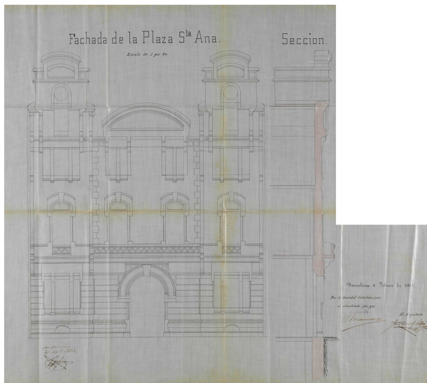
Fig. IV.LXIII. (sup.) Alzado y Sección de la fachada Montsió, esc.1:50, José Doménech y Estapá, 6 de febrero de 1893 / Fig. IV.LXIV. (inf.) Alzado y Sección de la fachada principal, esc.1:50, José Doménech y Estapá, 6 de febrero de 1893 / [AMCB: Exp.Fo-712-T, Q127 Obres Majors].
