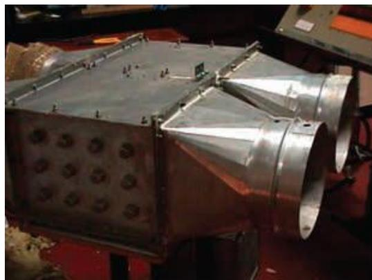
[V.19]. Batería de heat pipe aleteados en acero inoxidable en los que se ha hecho el vacío en el interior empleada en un sistema de climatización.
