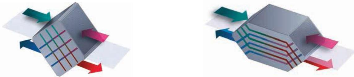
[V.18]. Recuperador estático de placas de flujos cruzados y recuperador estático de placas de flujos paralelos.
