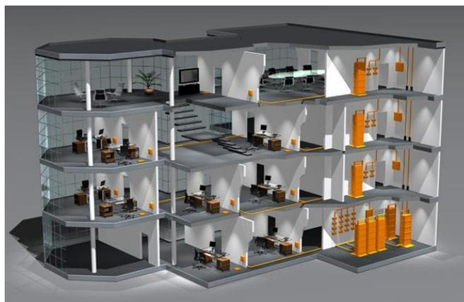
[4.07]. *Armarios repartidores de las instalaciones de cableado estructurado en un edificio de oficinas.*
