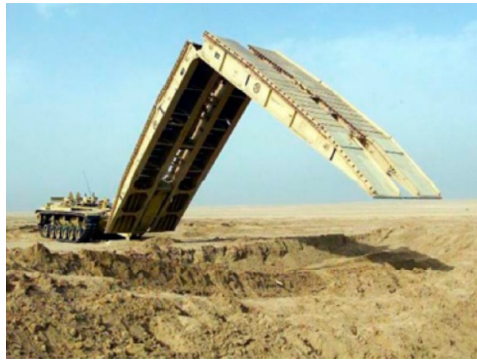
Figura 6.11: Solución de puente ARPA/UCSD Composite Assault Bridge
