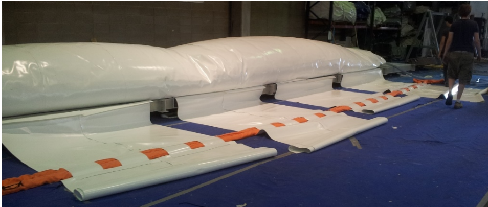
Figura 5.32: Bandas de tejido ancladas al tablero con pasadores para asegurar el contacto
