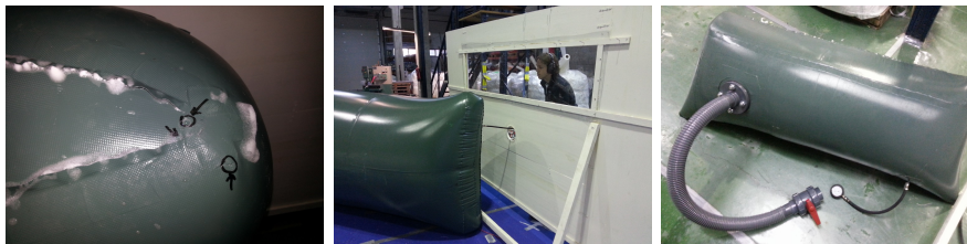
Figura 5.15: Comprobación de estanqueidad del material y las válvulas
