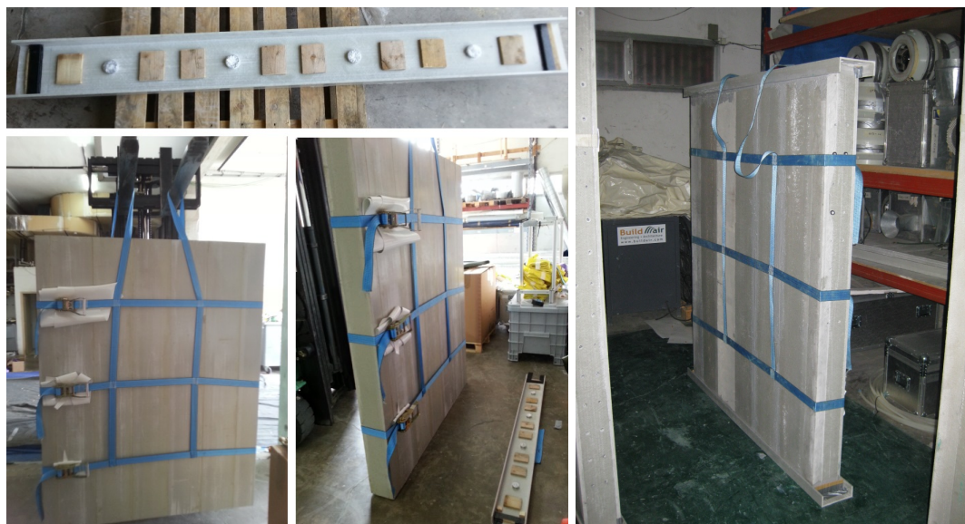
(a) Preparación de perfiles U de FRP para encolar en los extremos del panel
