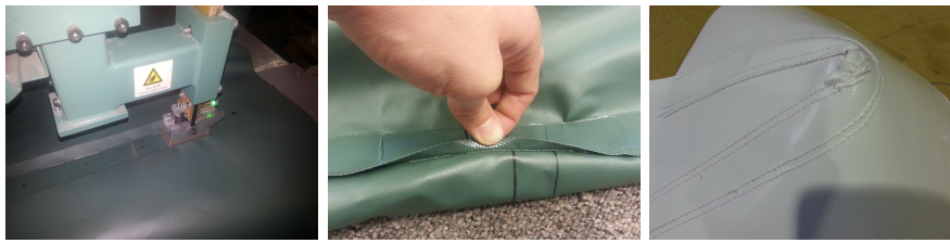
Figura 5.14: Pruebas de soldadura y costura de los tejidos
