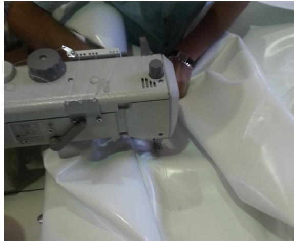
Figura 5.22: Costura de la punta de la cámara exterior del tubo hinchable
