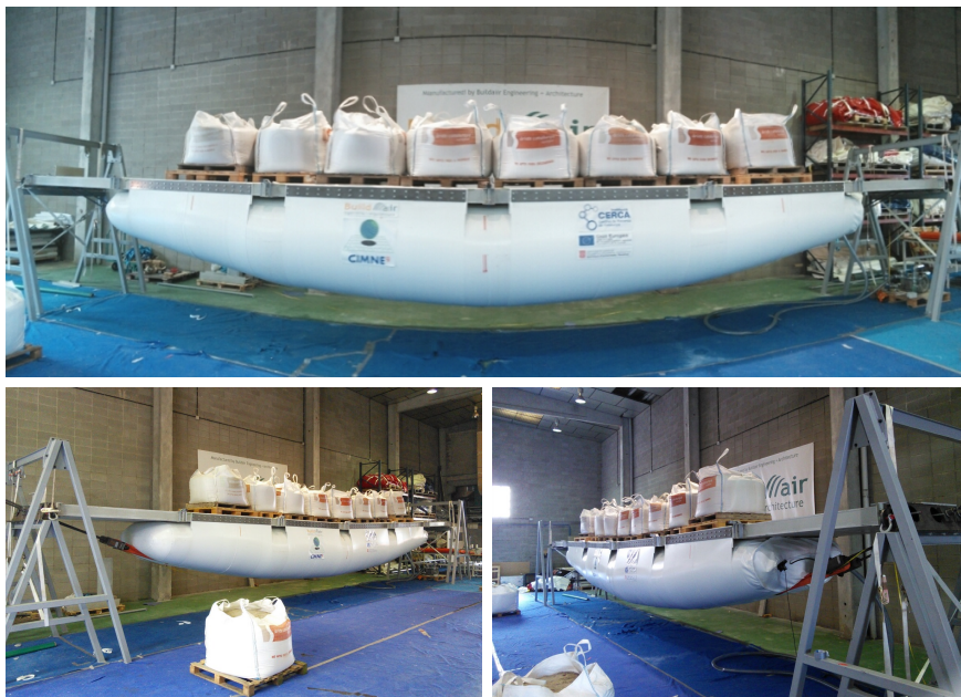
Figura 5.37: Prueba de carga de la viga 1 con 8 tn
