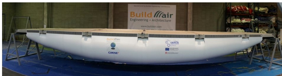
Figura 5.65: Puente completo formado por 2 vigas unidas
