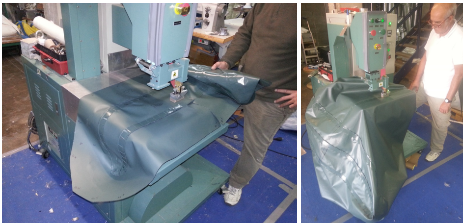
Figura 5.19: Soldadura de la punta de la cámara interior del tubo hinchable
