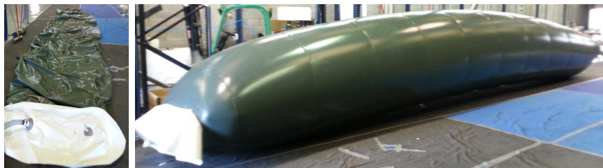
Figura 5.21: Cámara interior del tubo hinchable terminada
