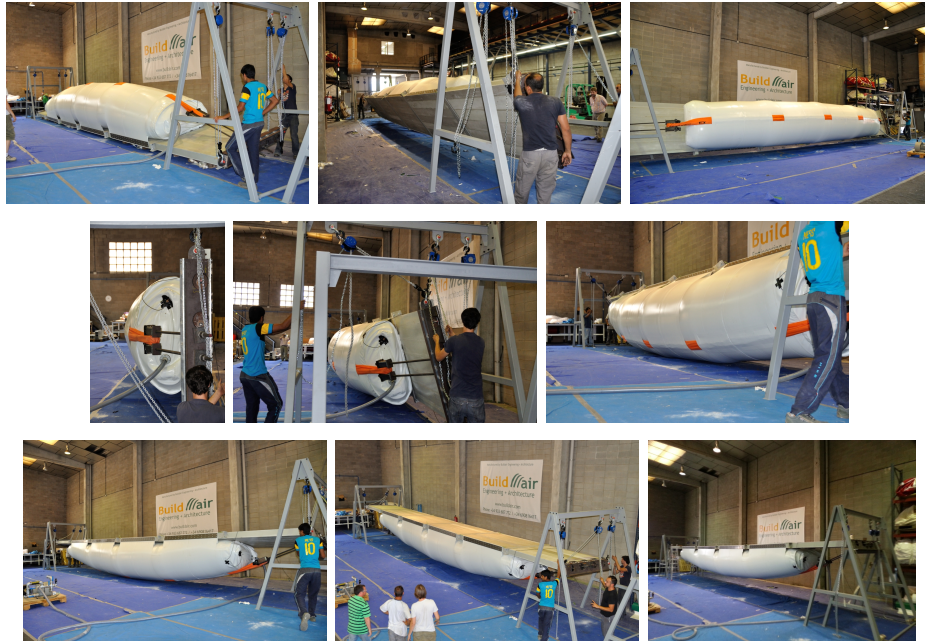
Figura 5.64: Maniobra de giro y posicionamiento de la viga
