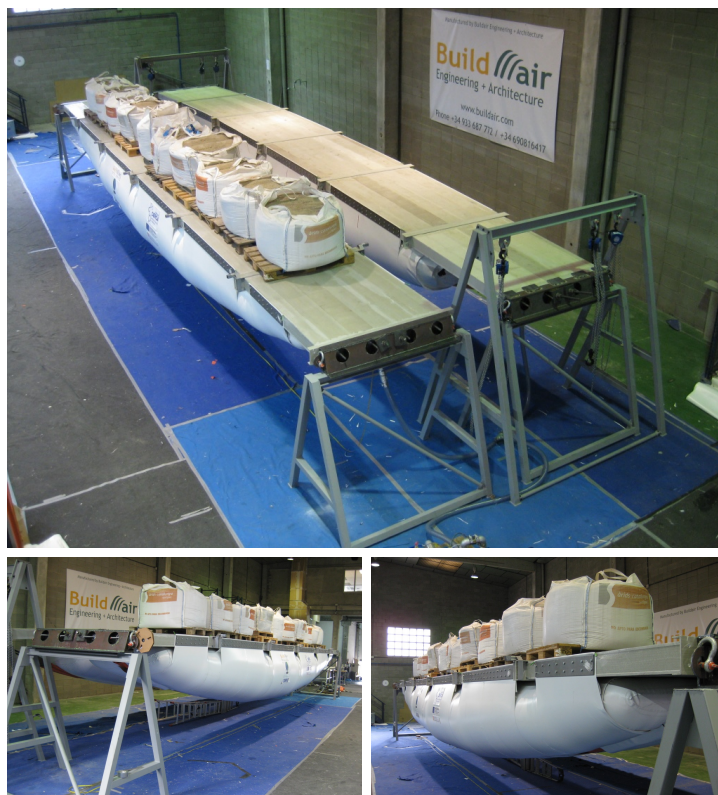
Figura 5.46: Prueba de carga de la viga 2 con 10 tn
