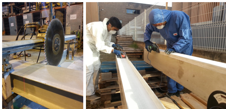
(a) Corte de los perfiles FRP
