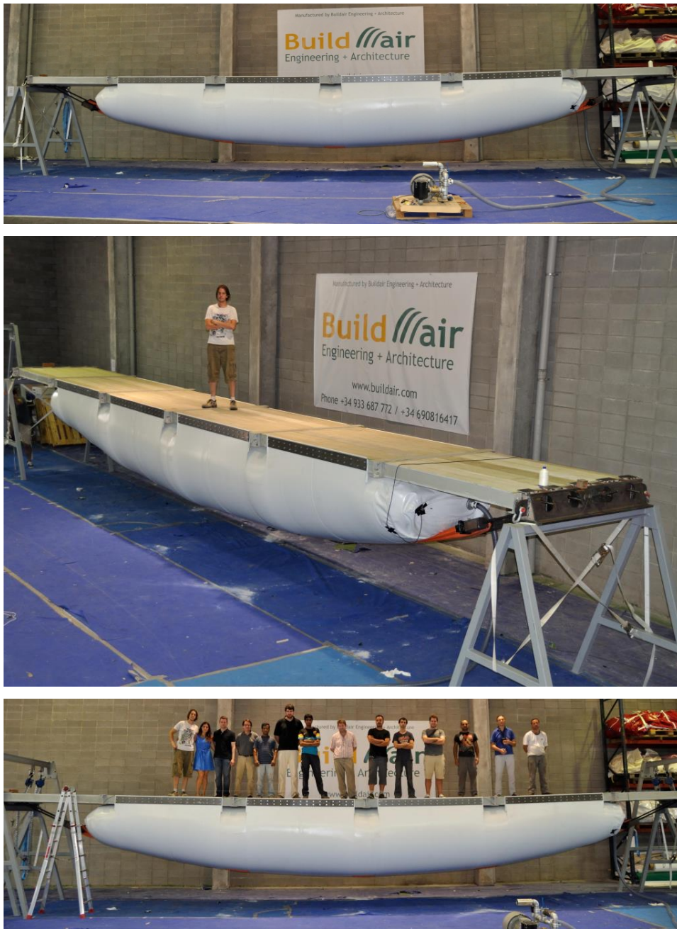
Figura 5.36: Primer prototipo de viga en posición final sobre caballetes
