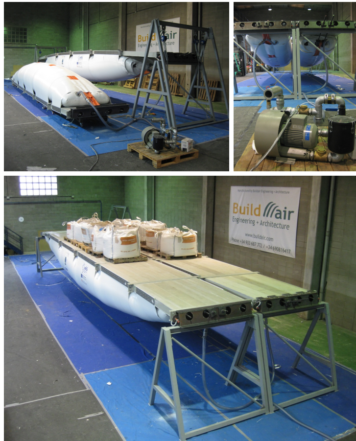
Figura 5.45: Prototipo final del puente con las dos vigas juntas
