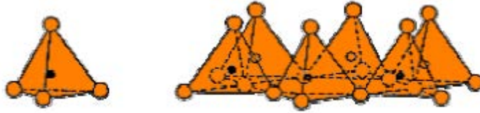
Figura 4.8. Tetraedros de silicato. Todos los silicatos están constituidos por una unidad estructural común, un tetraedro de coordinación Si-O. El silicio situado en el centro del tetraedro está rodeado de 4 oxígenos situados en los vértices. Este grupo tetraédrico se encuentra descompensado eléctricamente (\text{SiO}_4)^{-4} , por lo que los oxígenos se coordinan a otros cationes para compensar sus cargas. Fuente: Cortés, 2007.
