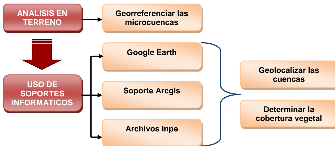
Figura 5.6. Metodología para la determinación de la situación inicial. Los análisis en terreno implican la georreferenciación con GPS para la delimitación de las microcuencas. El levantamiento de la información es llevada a soportes informáticos –como Googleearth y los archivos inpe– para su análisis, y de esta forma geolocalizar las microcuencas a través de Arcgis y determinar la cobertura vegetal. Fuente: Elaboración propia.
