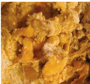
Macrofotografia de sals cristal·litzades a l'interior del morter. © Mercè Marquès
