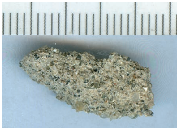
Macrofotografia d'una mostra de morter de construcció de l'arc de la finestra. Foto: Patrimoni 2.0
