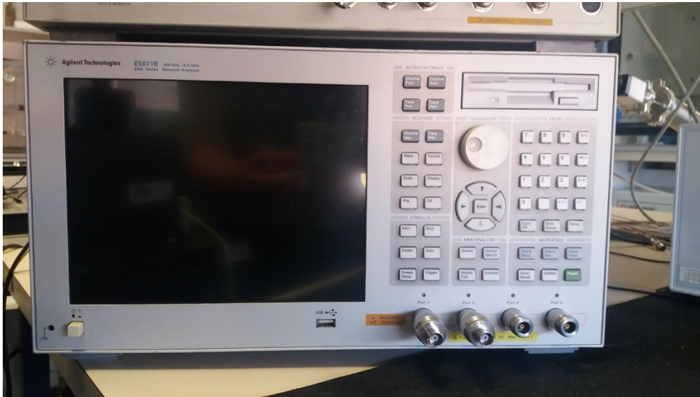
Analizador de redes: AGILENT E5071B ENA Series (300kHz-8.5GHz)
