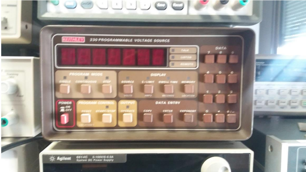
Fuente de tensión DC: KEITHLEY 230 Programmable Voltage Source.
