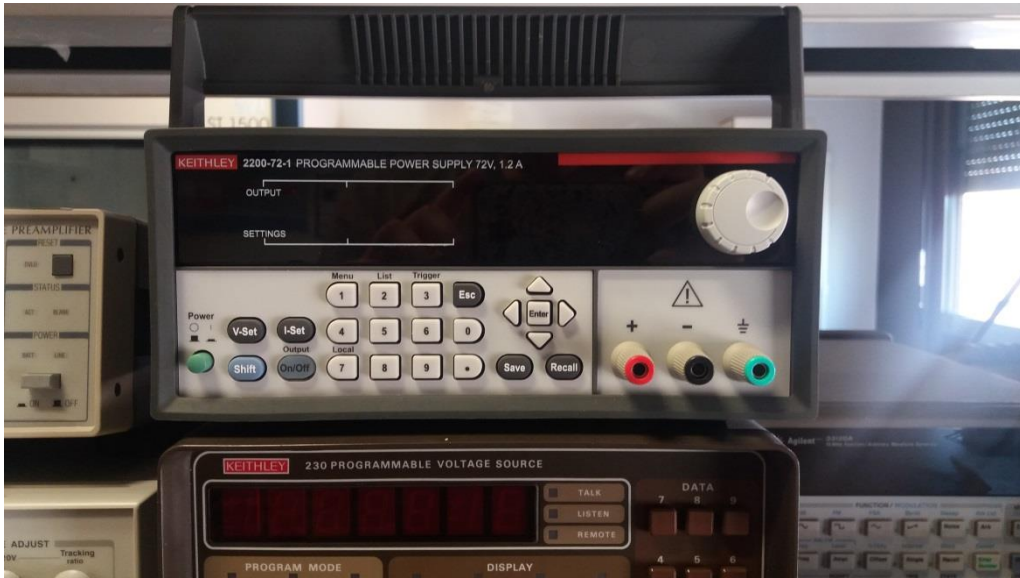
Fuente de tensión DC: KEITHLEY 2200 Programmable Power Supply (72V, 1.2A).
