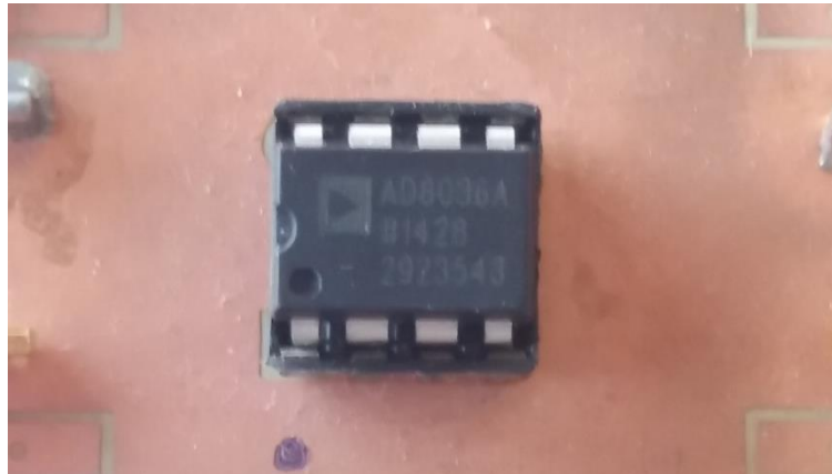
Limitador de amplitud (en placa): AD8036 Analog Devices (Voltage Feedback Clap Amp)
