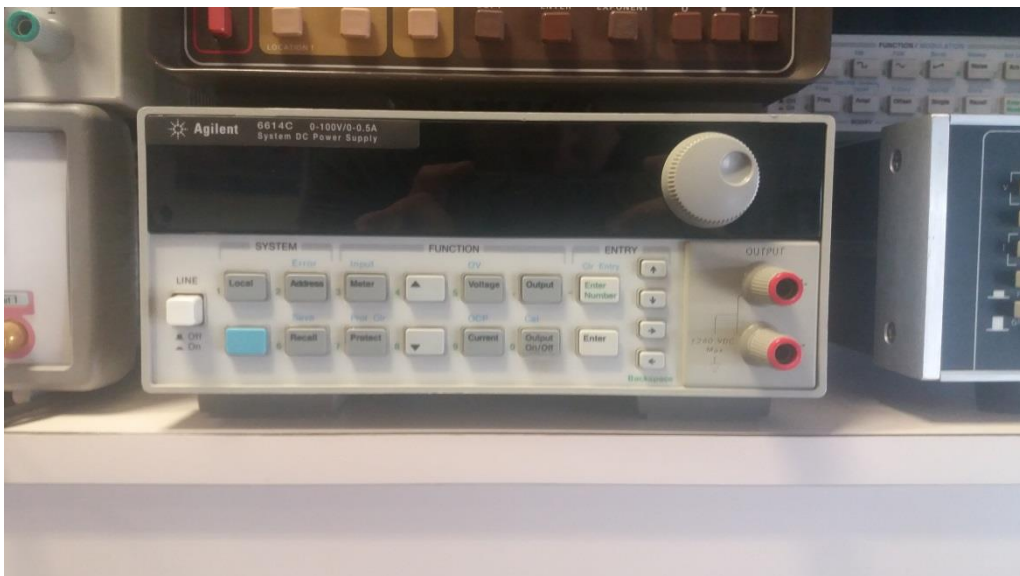
Fuente de tensión DC: AGILENT 6614C System DC Power Supply (0-100V ; 0-0.5A).
