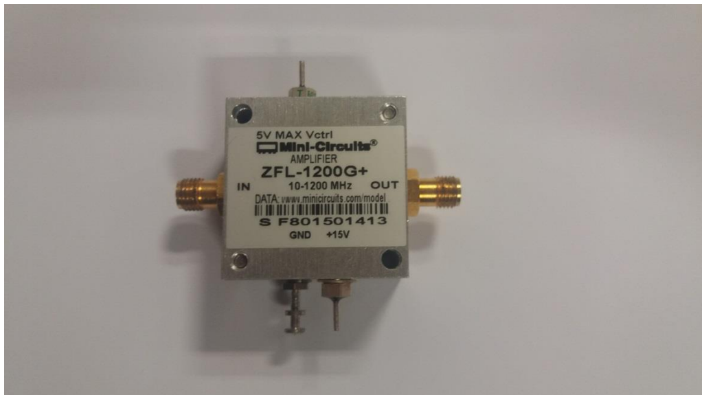
Amplificador de ganancia regulable: Minicircuits ZFL-1200G+
