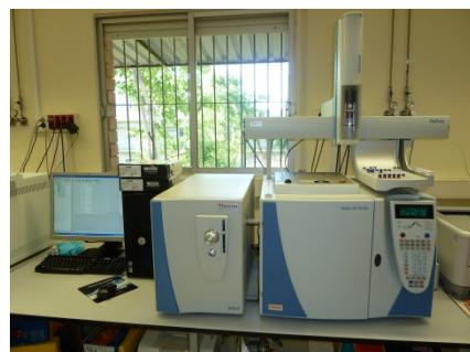
**Figura 3.10. L'equip de cromatografia de gasos acoblat a un espectròmetre de masses.**
