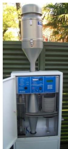
**Figura 3.3. Captador d'alt volum Digitel DHA-80 per a la determinació de  $\text{PM}_1$ .**
