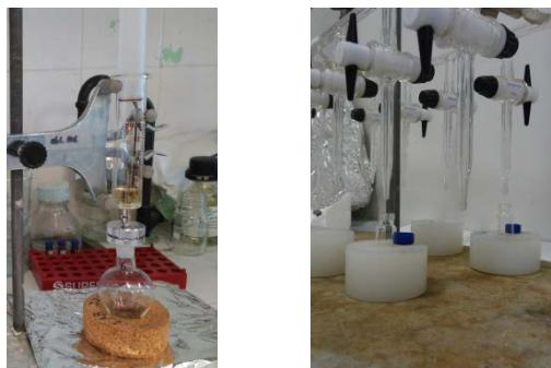
**Figura 3.7. Etapes de filtració (esquerre) i concentració al vial per evaporació sota flux de nitrogen (dreta).**
