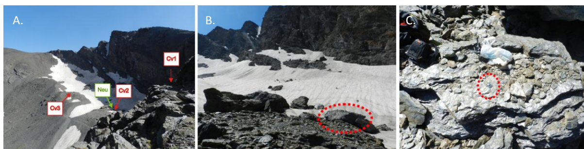
Fig. 6.6 – A. Perspectiva oblicua del Circo glaciar del Veleta a 3100 m de altitud y localización de los Thermochrons ; B. Situación del Thermochron CV2 en la parte oeste del circo glaciar; C. Detalle del Thermochron CV2 instalado sobre una roca con buena exposición al nadir. Fuente: Fotografías gentilmente cedidas por el Dr. M. Oliva.
